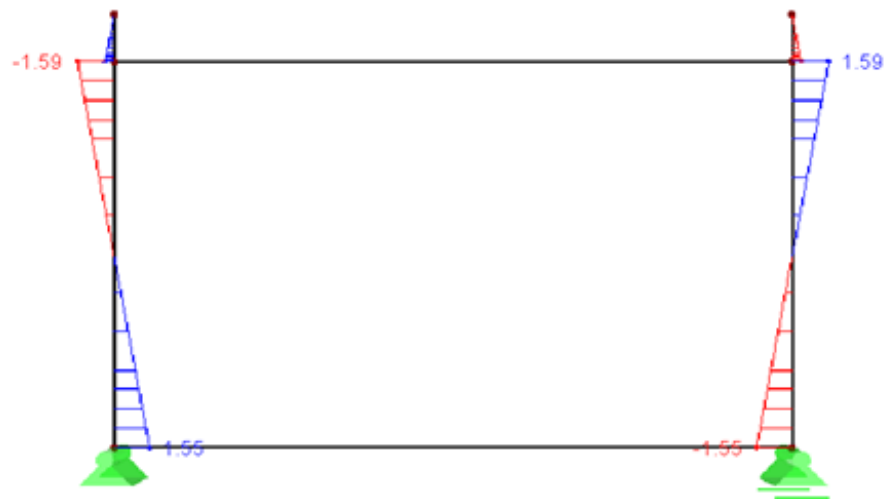
Slika 35: Dijagram poprečnih sila od opterećenja vjetrom kada puše na poprečnu stranu objekta
