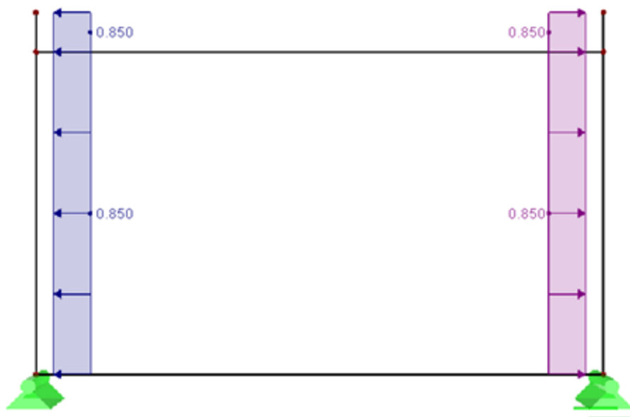
Slika 27: Prikaz 2D proračunskog modela sa opterećenjem vjetra kada puše na poprečnu stranu objekta
