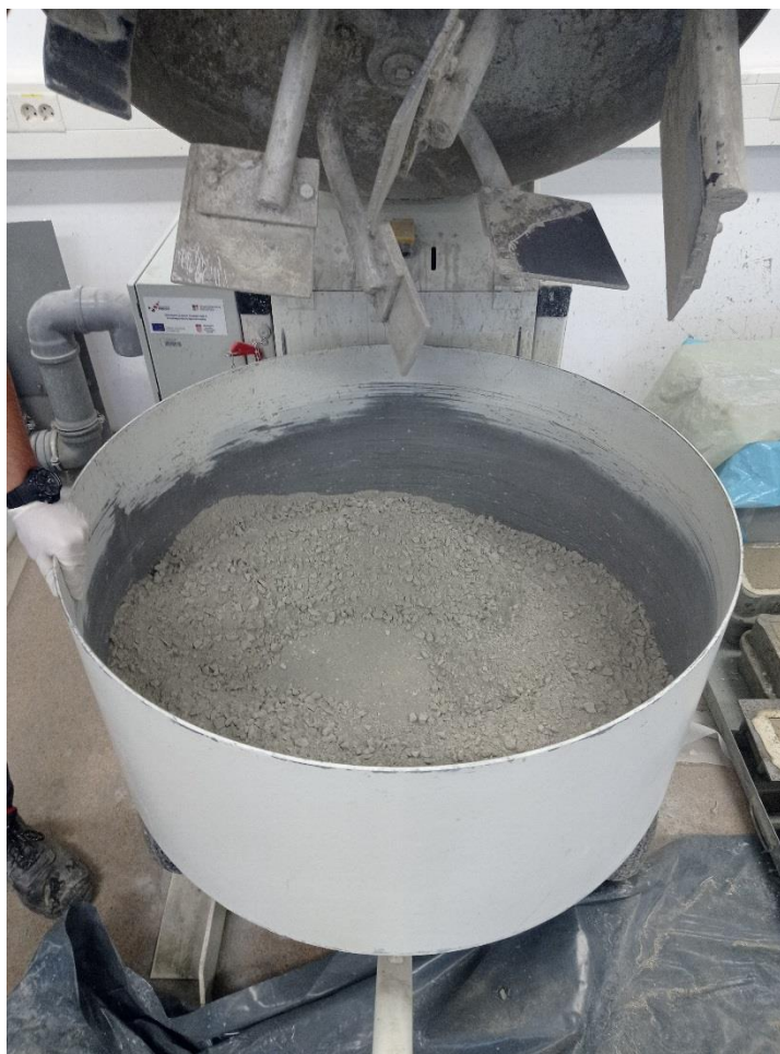
Slika 19: Planetarna miješalica u laboratoriju za materijale
