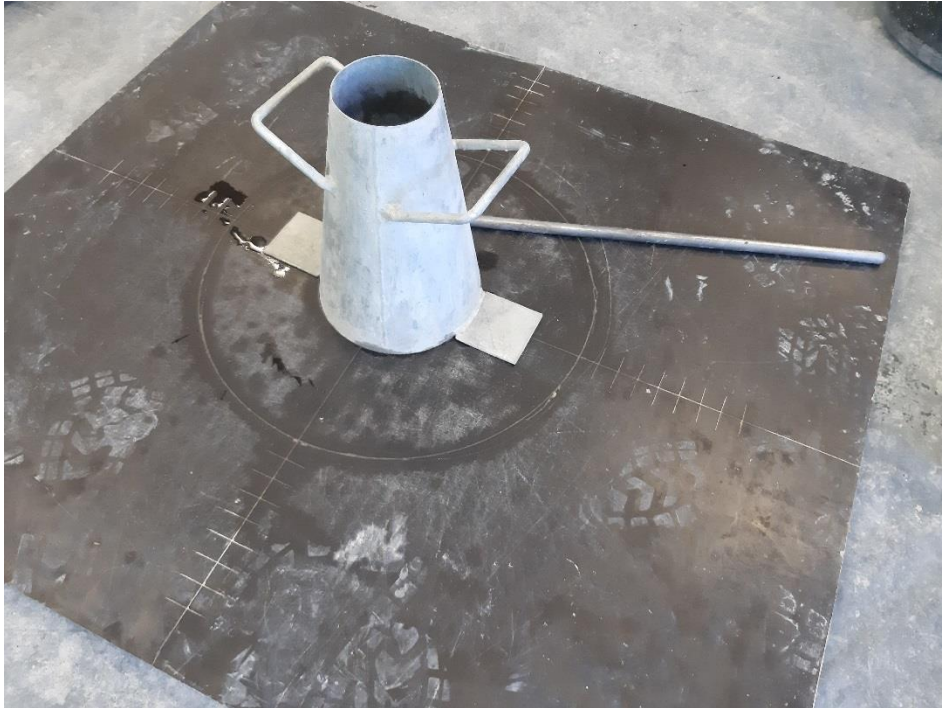
Slika 4: Kalup za izvođenje ispitivanja slijeganjem
