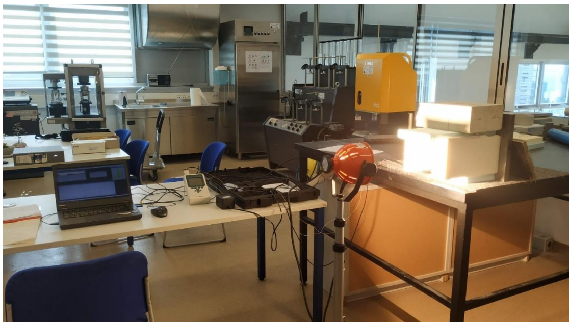
Slika 22: Postav opreme za ispitivanje toplinske provodljivosti
