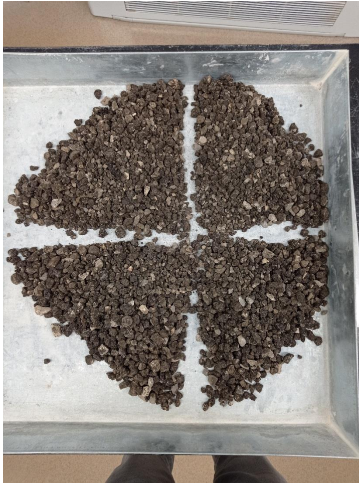
Slika 17: Dijeljenje agregata na četvrtine
