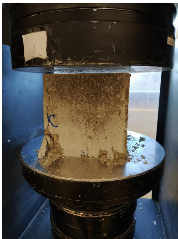
Slika 31 Slom uzorka pod utjecajem tlačne sile na mješavini 4
