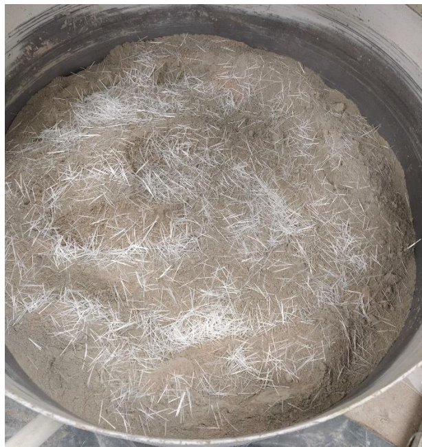
Slika 14 Dodavanje staklenih vlakana mješavini 4
