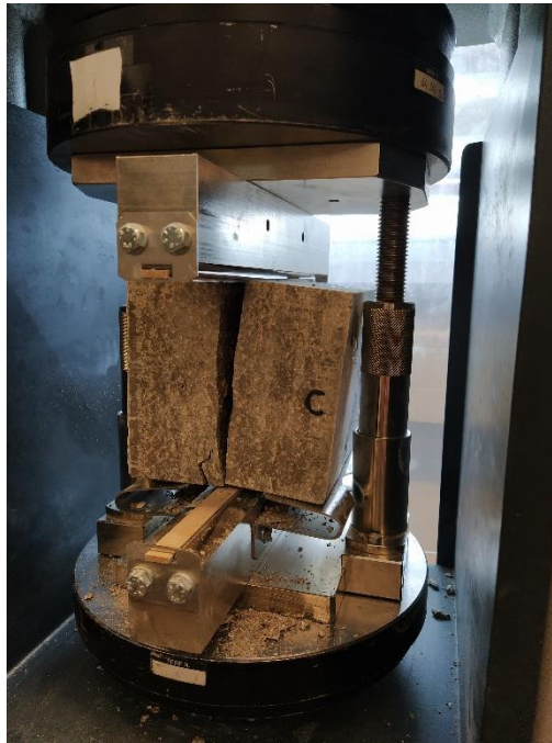
Slika 34 Preša s ugrađenim nastavkom za nanošenje vlačne čvrstoće cijepanjem
