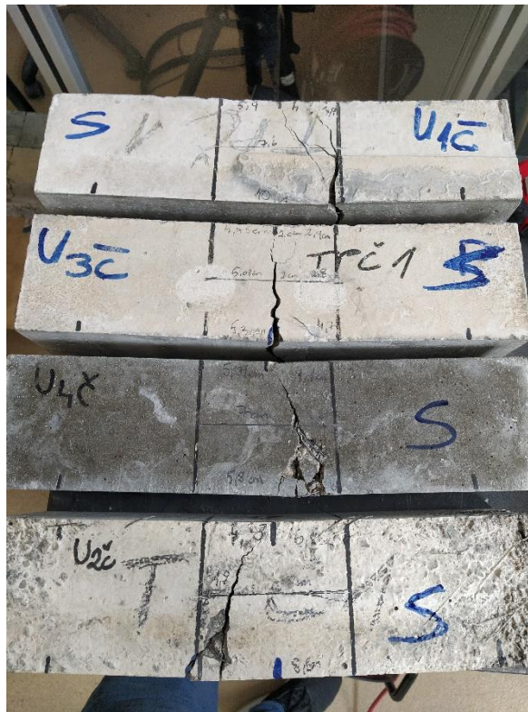
Slika 48 Slom uzoraka mješavine 2
