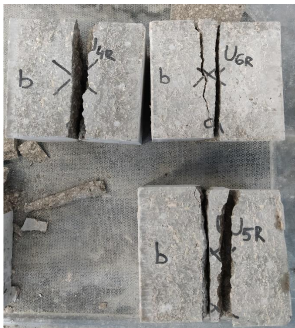
Slika 35 Slom uzoraka prilikom nanošenja vlačne sile cijepanjem mješavine 1
