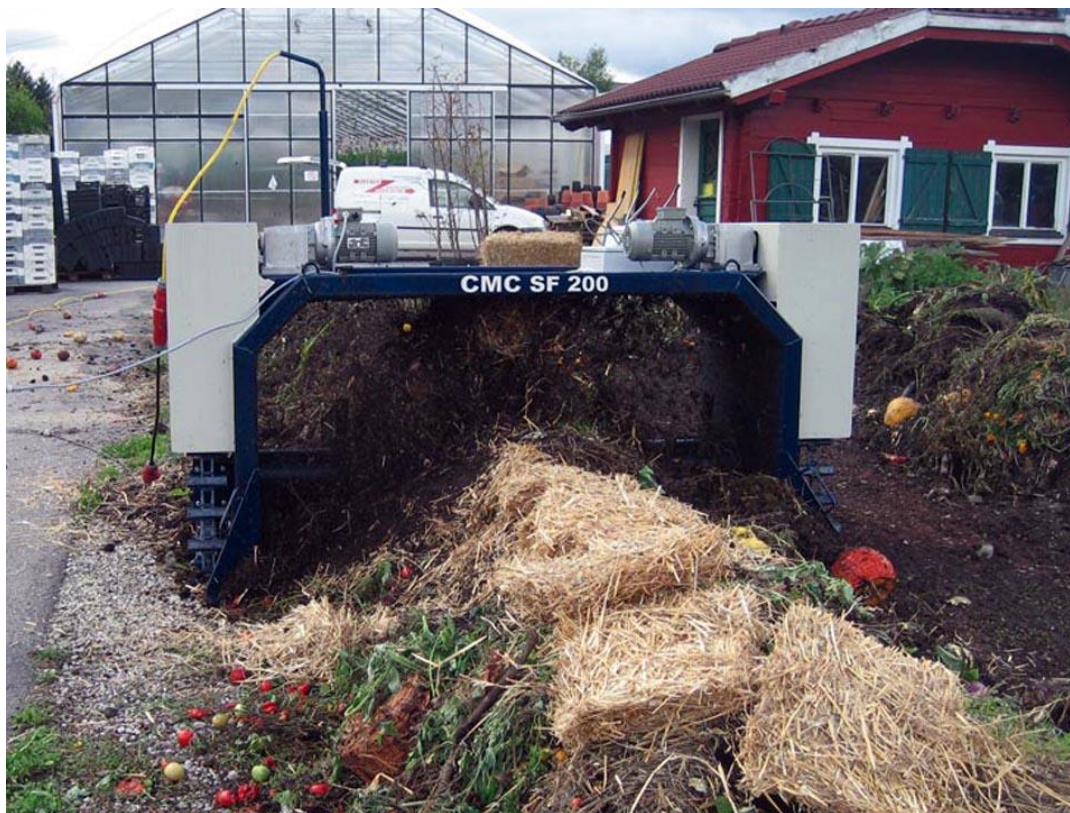
Slika 29. Samohodni električni prevrtač kompostnih hrpi (izvor: https://www.compost-systems.com/en/green/maschinentchnik/selbstfahrend datum pristup: 5.6.2021)
