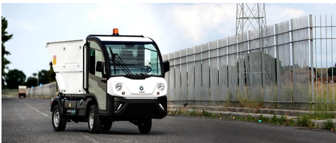
Slika 5. Električno vozilo za sakupljanju otpada u komunalnoj tvrtki Goupil G4 (izvor: katalog proizvoda Goupil G4)
