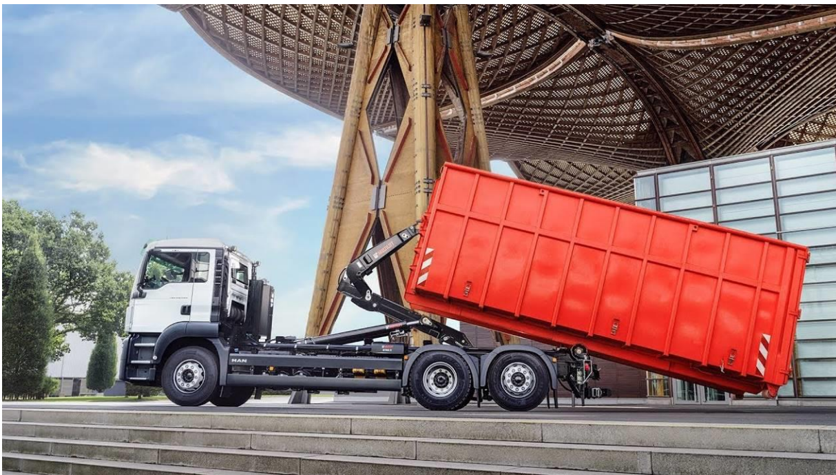
Slika 18. Auto navlakač s roll spremnikom za miješani komunalni otpad(izvor: https://www.youtube.com/watch?v=G7qr8CA_hsw&ab_channel=Hiabglobal datum pristupa: 29.5.2021)
