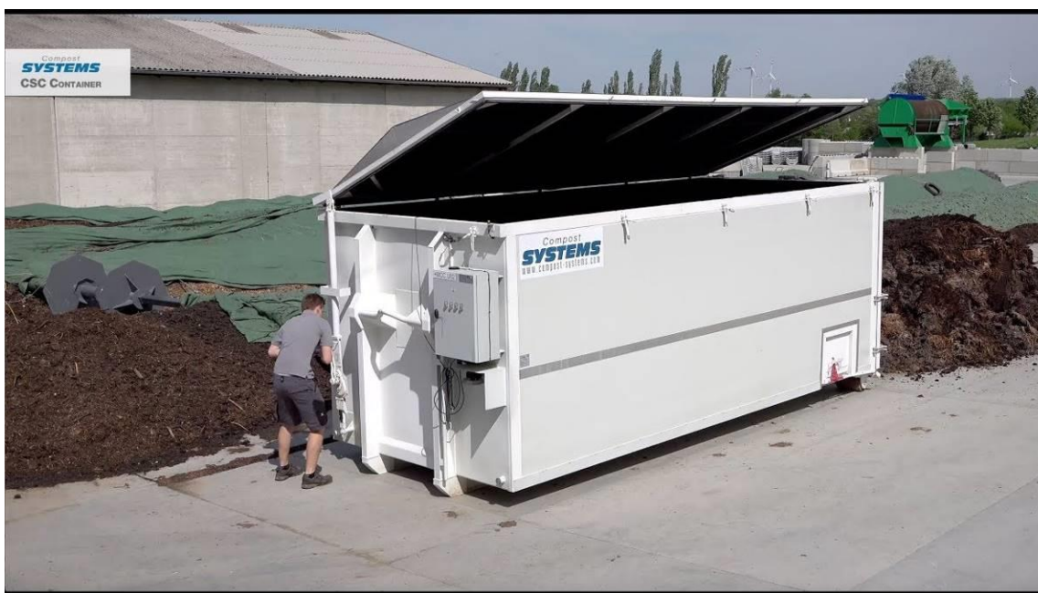
Slika 27. Spremnik za aerobno kompostiranje i stabilizaciju biorazgradivog otpada (izvor: https://www.youtube.com/watch?v=wBTvgTleaQY&ab_channel=CompostSystems/ datum pristup: 5.6.2021)
