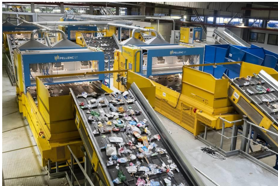
Slika 26. Optički stroj za sortiranje s prilaznim transporterima za dopremu korisnog otpada (izvor: https://www.linkedin.com/company/pellenc-selective-technologies/ datum pristup: 4.6.2021)
