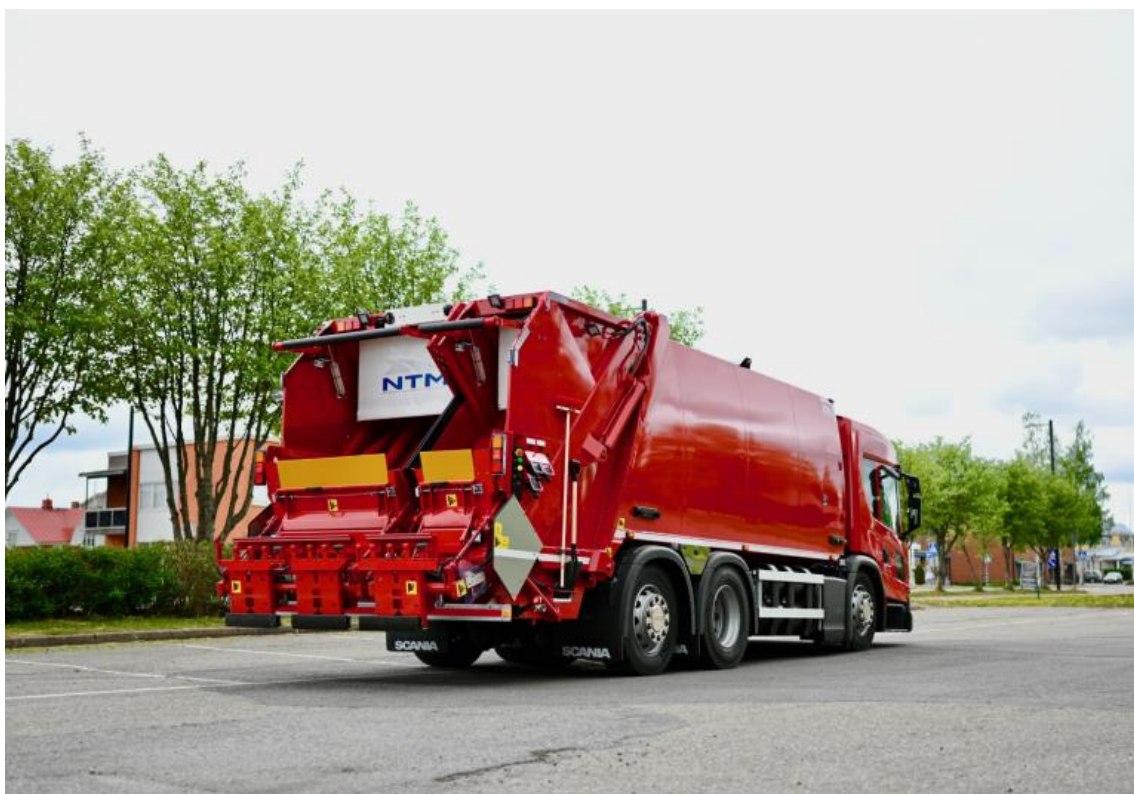
Slika 6. Dvokomorna nadogradnja za prikupljanje otpada tvrtke NTM (izvor: katalog proizvoda NTM)
