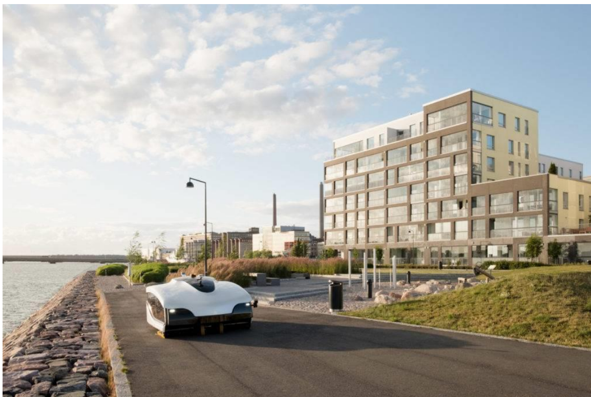
Slika 36. Električna autonomna čistilica Trombia free u pokusnom radu (izvor: https://trombia.com/free/ datum pristupa 7.6.2021)
