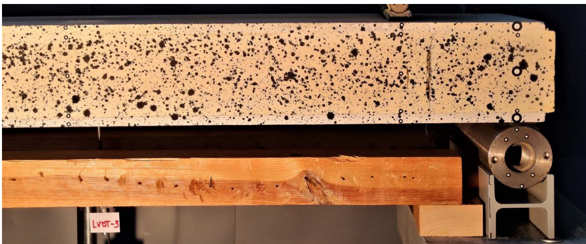
Slika 3.13 Prikaz pozicija crno-bijelih točaka
