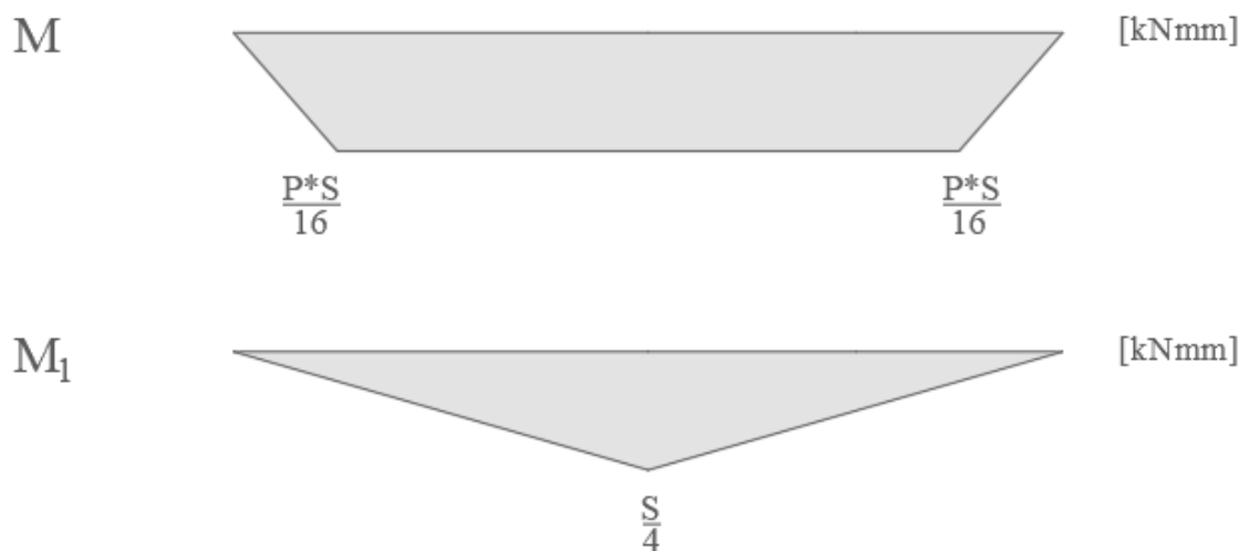
Slika 3.27 Dijagrami momenata savijanja uzorka te od jedinične sile na sredini raspona
