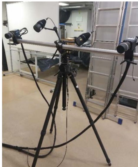
Slika 3.11 ARAMIS 12M optički mjerni sustav
