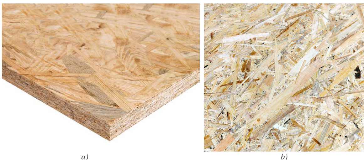
Slika 2.8 OSB a) ploča, b) raspored iverja
