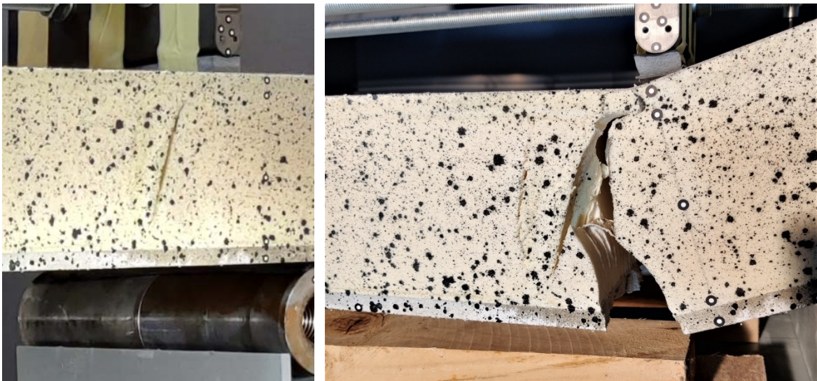
Slika 3.21 Prikaz pukotine a) prije i b) nakon sloma uzorka P2-Fp2-45
