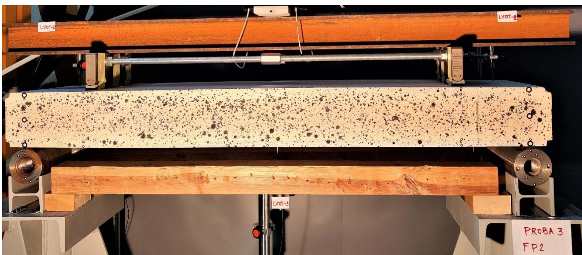
Slika 3.16 Prikaz uzorka P3-Fp2-45 prije početka ispitivanja
