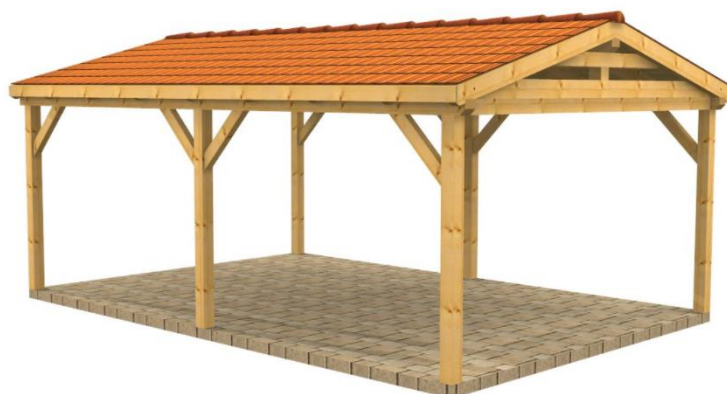
Slika 7: Primjer nadstrešnice s drvenom konstrukcijom okvira [16]
