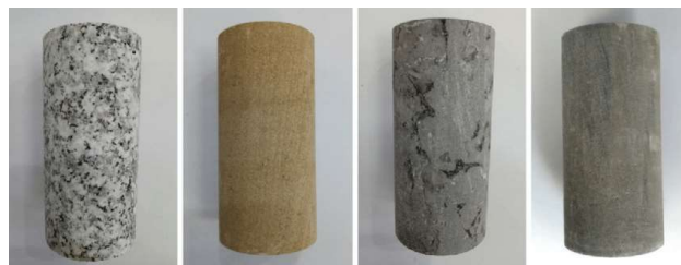
Slika 7: Primjeri intaktnih stijena (s lijeva na desno): granit, žuti pješčenjak, vapnenac, crni pješčenjak [8]
