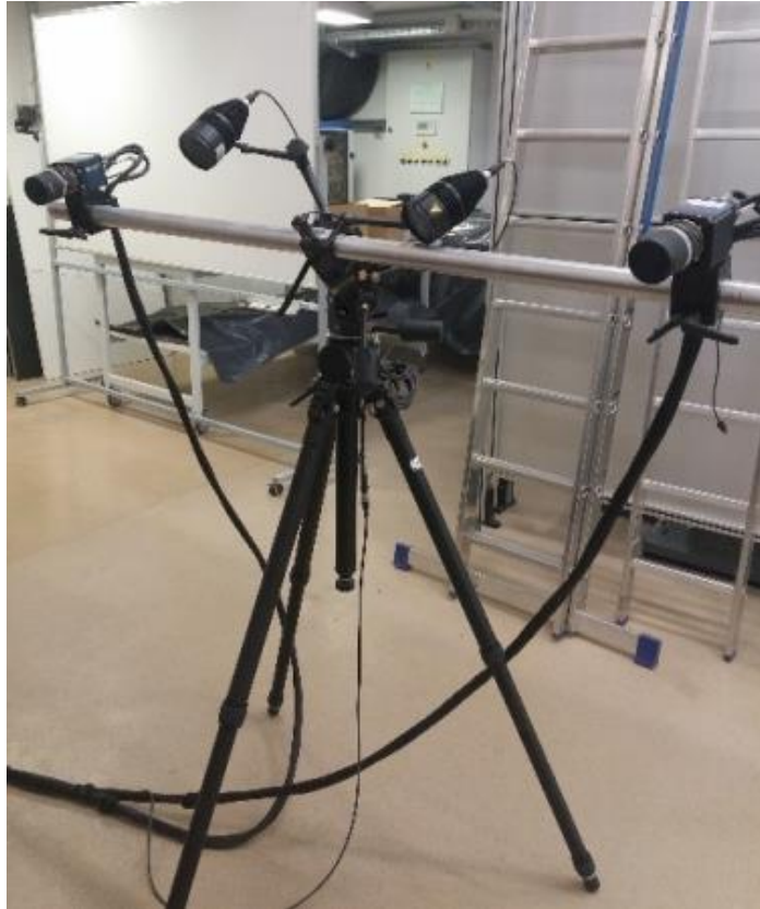
Slika 4. Optički mjerni sustav GOM mbH PONTOS 3D 4M
