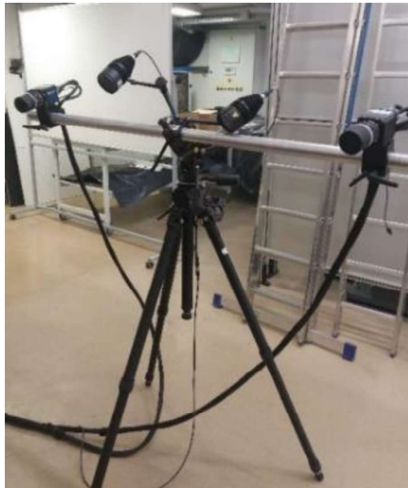
Slika 14: Sustav kamera za 3D optičko mjerenje [7]
