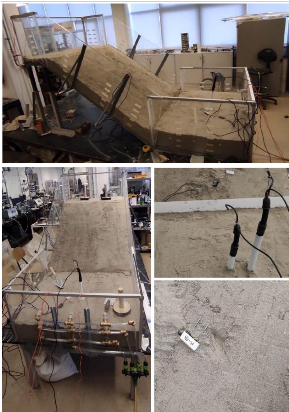
Slika 16: Ugradnja mjerne opreme i materijala u statičkom modelu [9]
