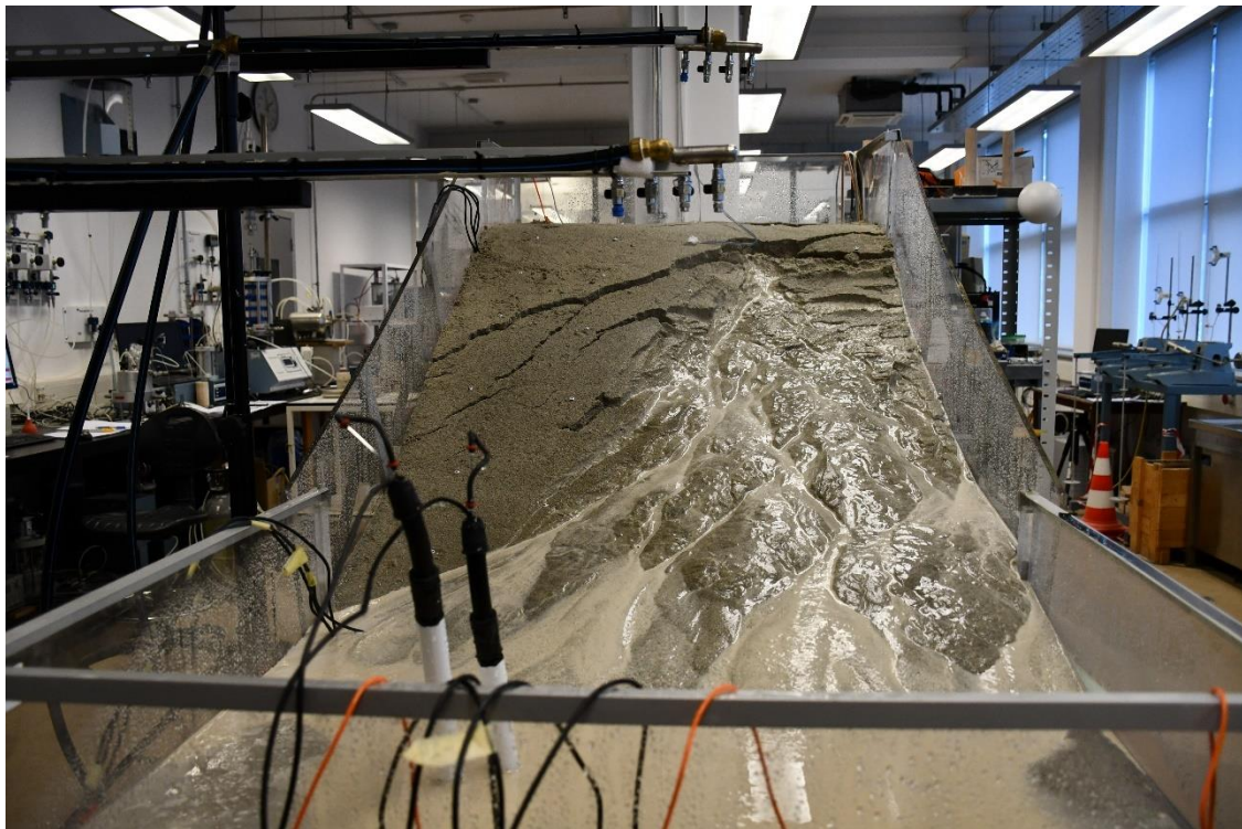
Slika 32: Površinsko ispiranje materijala
