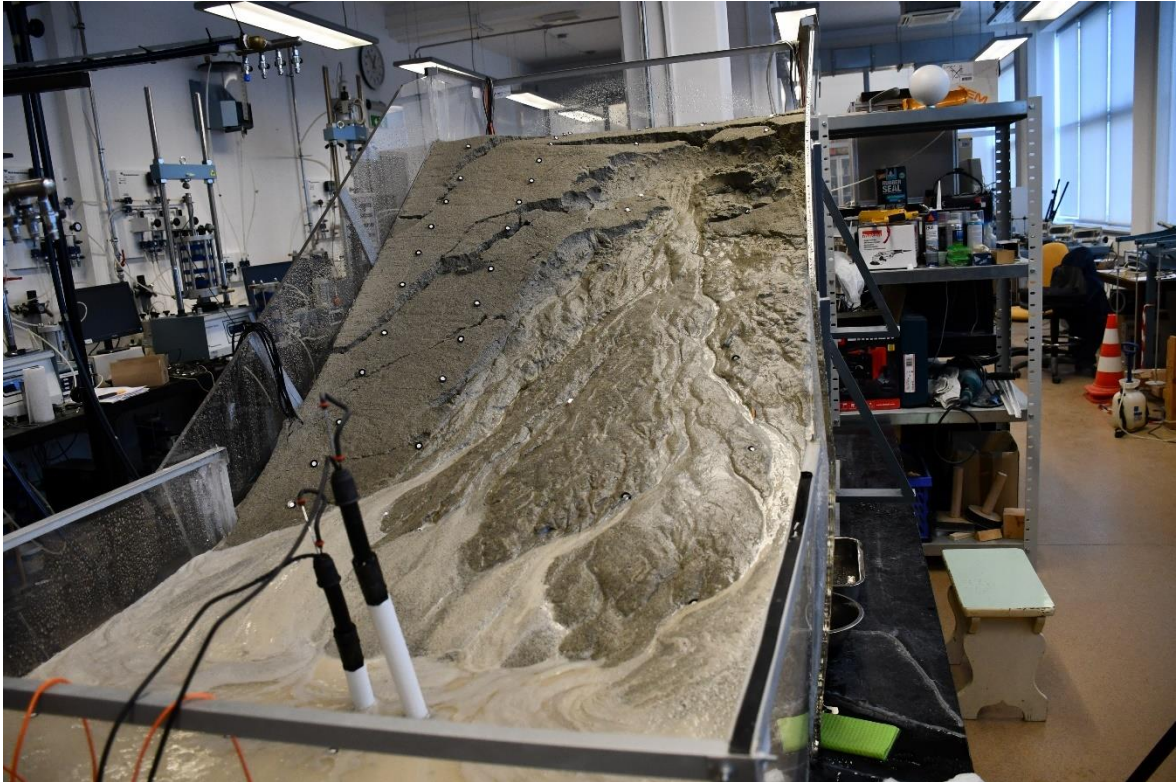
Slika 47: Prikaz kliznog tijela i potopljene nožice modela u pokusu 2
