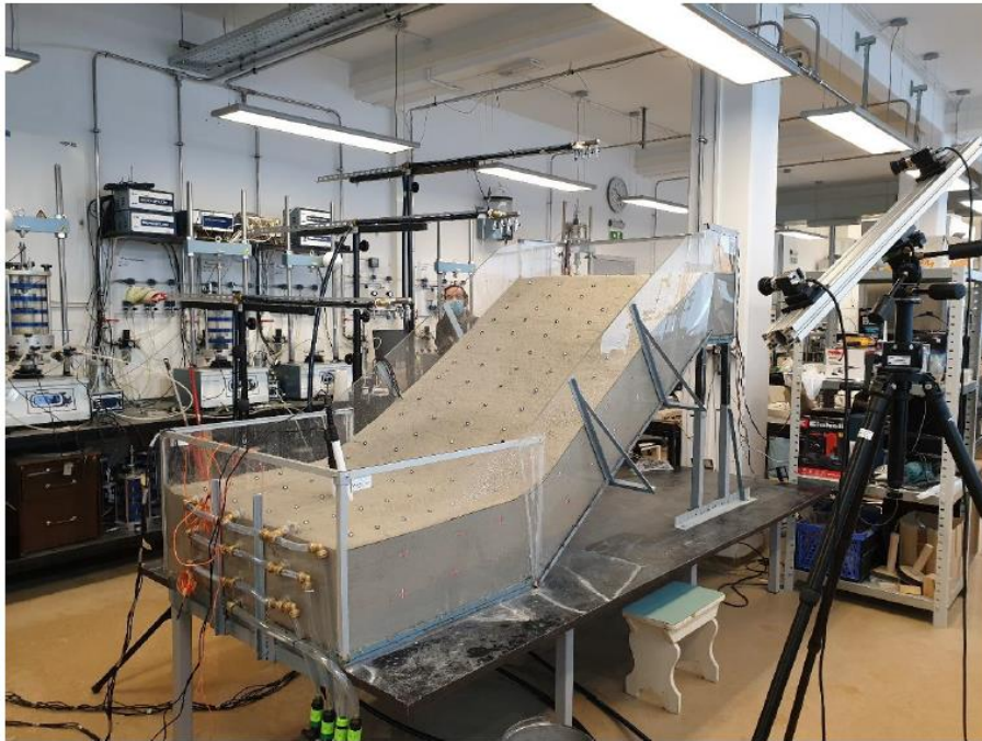
Slika 17: Umanjeni fizički model kosine sa ugrađenom mjernom opremom i mjernim točkama na površini modela [9]
