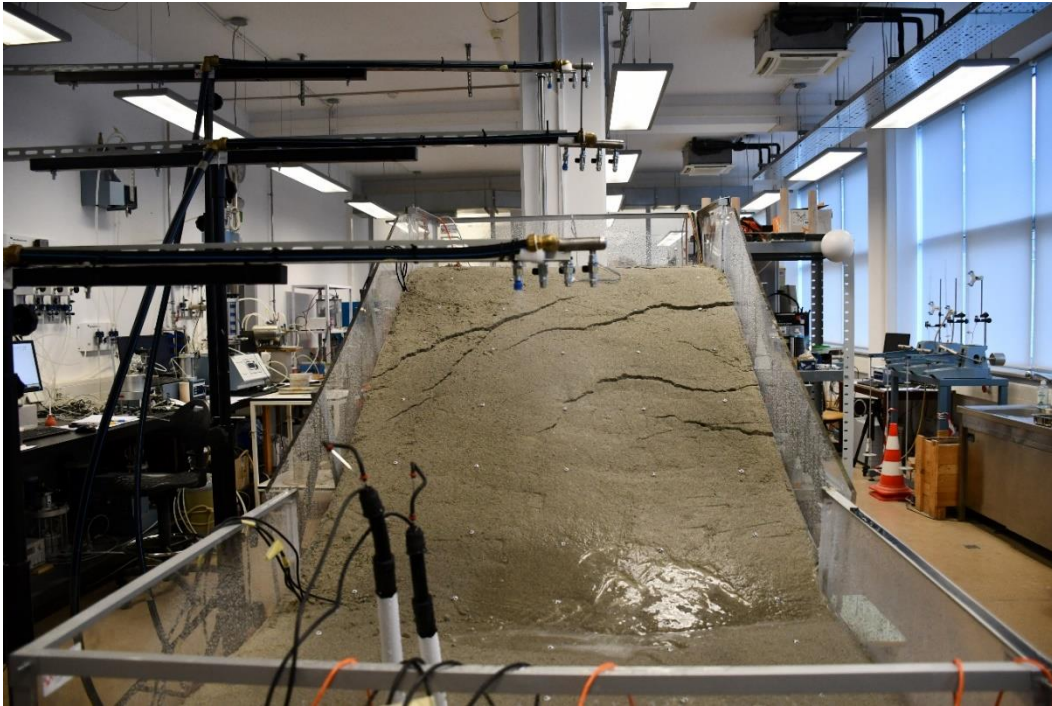
Slika 29: Prikaz pukotina tijekom pokusa 1
