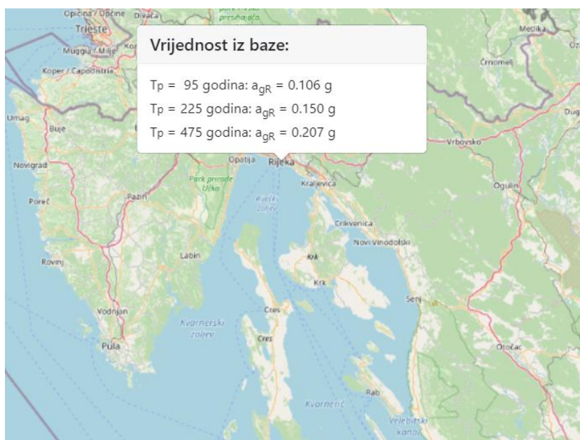
Slika 32. Vrijednosti vršnih ubrzanja tla za različite povratne periode na području Grada Rijeke [39]
