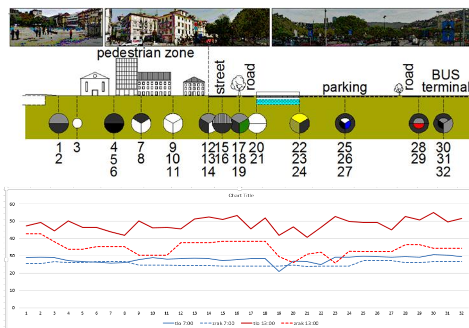
Slika 5.12: Prikaz temperatura različitih tipova površina na presjeku 03.07.2012. (Cuculić, Deluka-Tibljaš and Babić 2014)
