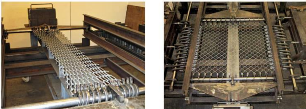
Slika 50. Ispitivanje vlačne čvrstoće mreže
