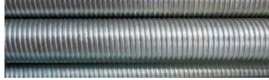
Slika 81. Elektro - cinčani čelik
