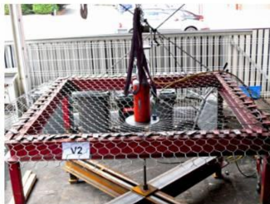
Slika 51. Ispitivanje mreža na proboj
