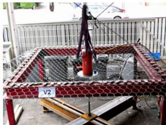
Slika 51. Ispitivanje mreža na proboj
