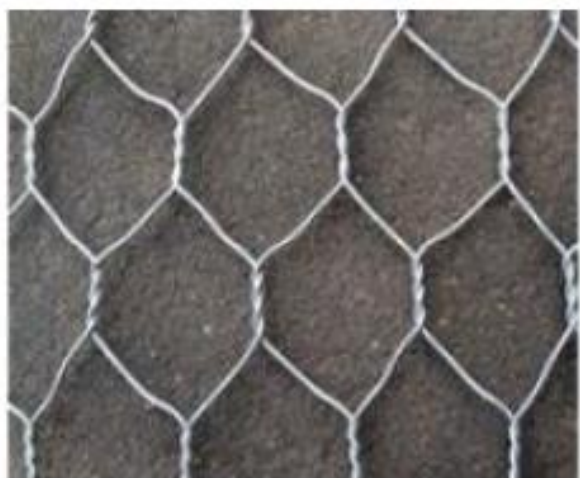
Slika 52. Dvostruko i jednostruko uvijena mreža
