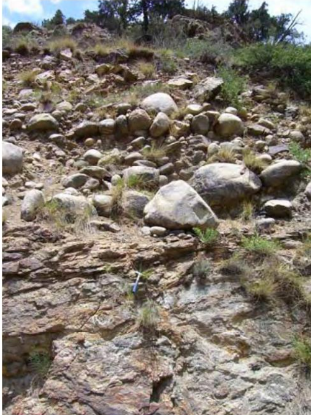
Slika 33. Blok u matriksu - oblik bloka
