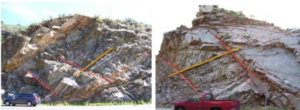
Slika 26. Diskontinuiteti – postojanost i orijentacija
