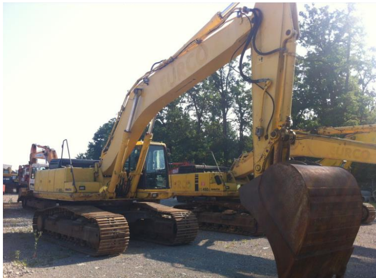
Slika 3: Bager Komatsu PC 450 LC-6
