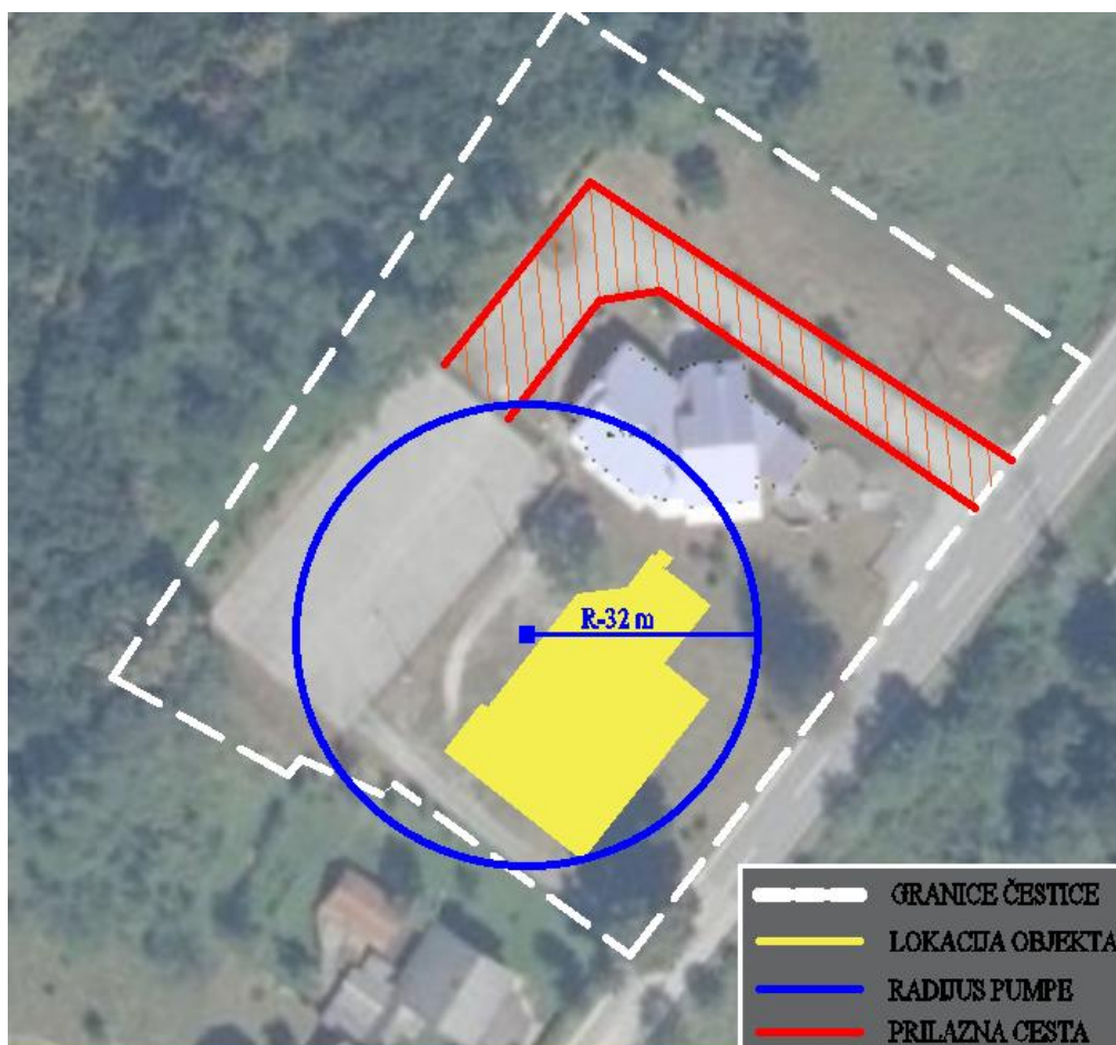
Slika 13: Radni krug autobetonske pumpe SCHWING BPL 900
