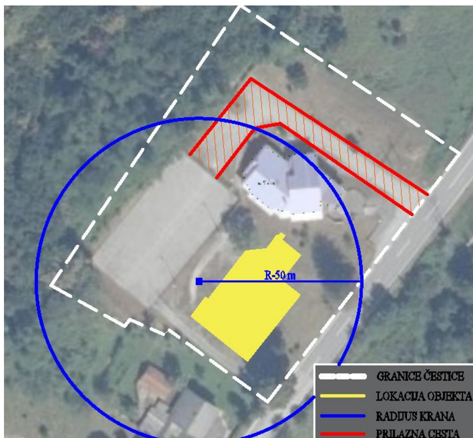
Slika 22: Radni krug kрана Terex CTT 91-5
