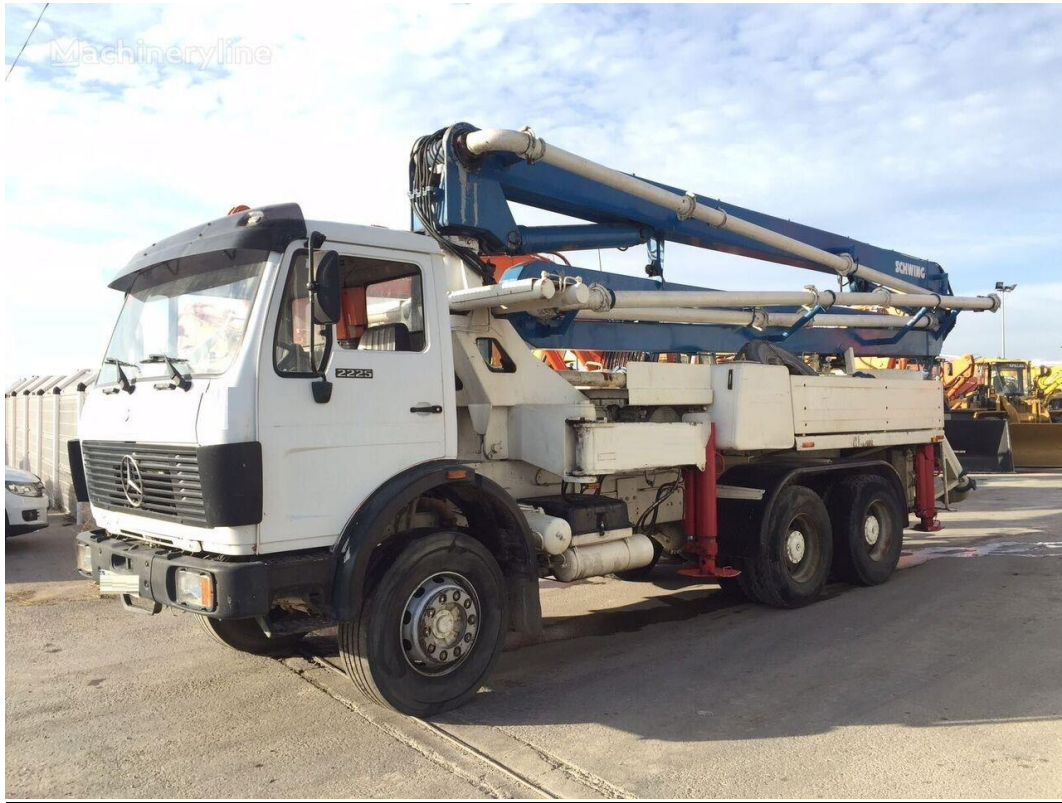
Slika 12: Autobetonska pumpa SCHWING BPL 900 Mercedes Benz 1722
