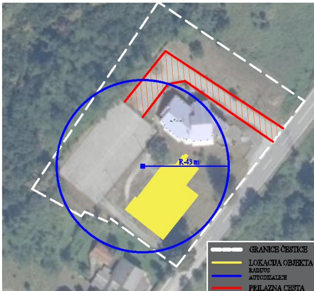
Slika 26: Radni krug autodizalice Grove GMK 3060
