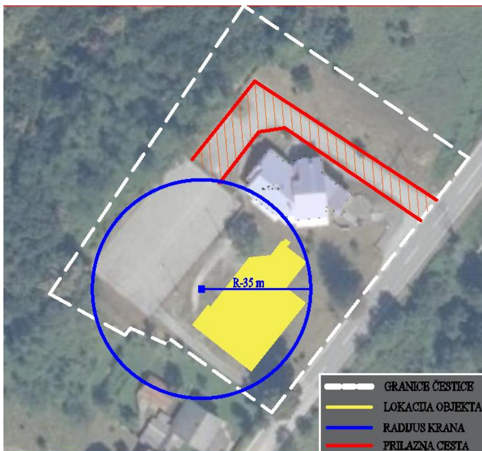
Slika 20: Radni krug krana Potain GTMR 331C
