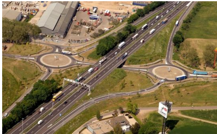
Slika 9: Kružno raskrižje "dumbbell" [7]
