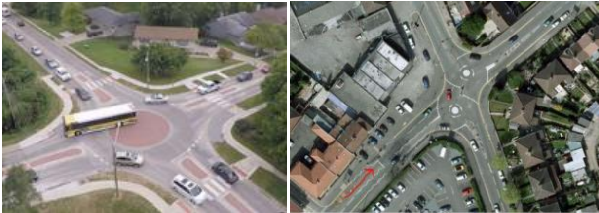
Slika 11: Mini kružno (lijevo) i dvostruko mini kružno raskrižje (desno) [9]
