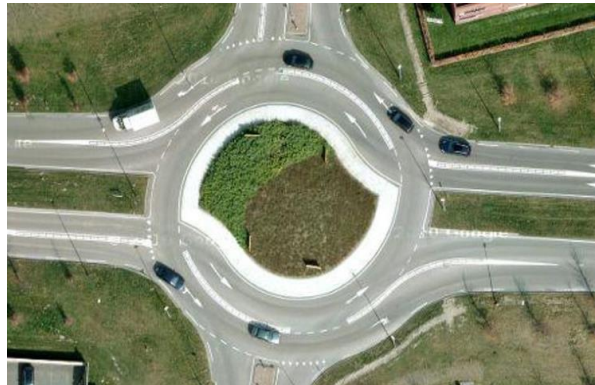
Slika 5: Izvanurbano turbo kružno raskrižje [6]
