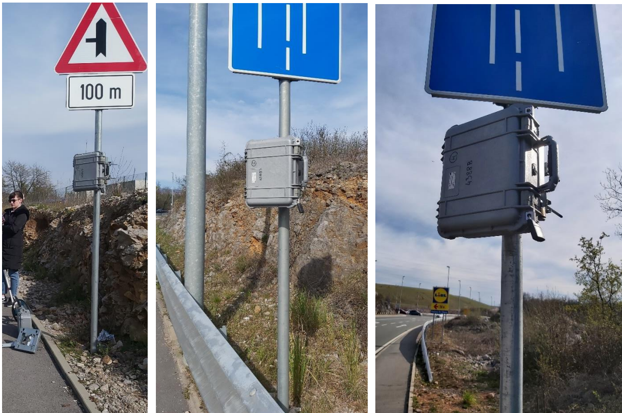
Slika 14 a, b i c: Postavljeni brojači na privozima raskrižja Marinići
