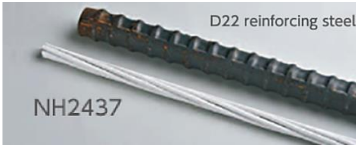
Slika 9: Šipka lijevo ima skoro jednaku čvrstoću kao šipka s desne strane [8]
