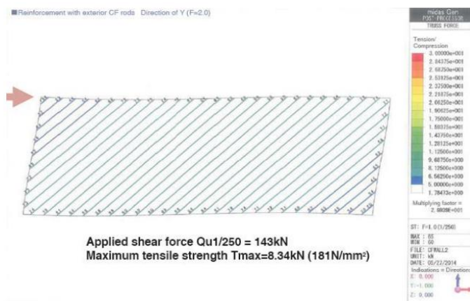
Slika 14: Analiza unutarnje primjene šipki [7]
