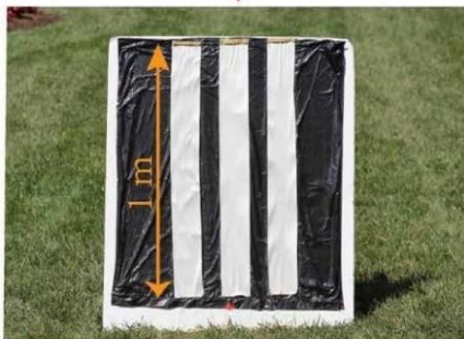
Slika 6: Prikaz premazivanja sloja vodikovog peroksida na neprozirno drvo izloženo jednosatnoj sunčevoj svjetlosti [1]
