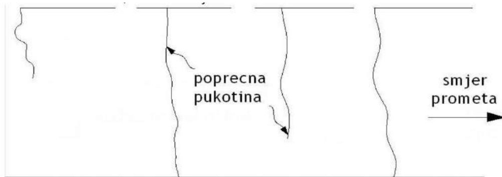
Slika 17: Shematski prikaz poprečne pukotine [12]
