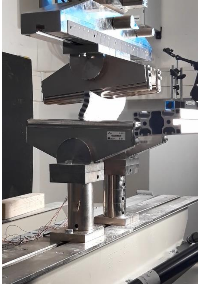
Slika 20: Izvijeni uzorak neposredno prije klizanja
