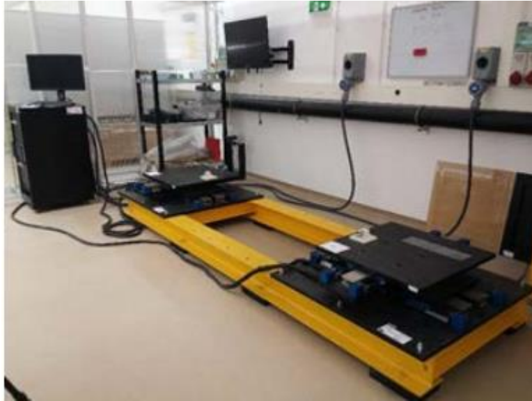
Slika 7. Dvoodsna potresna platforma Quanser STI-III, izvor GRađevinski fakultet u Rijeci [8]
