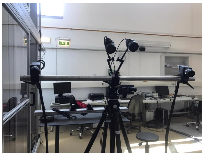
Slika 8. Optički mjerni sustav GOM mbH PONTOS 3D 4M, slikano na Građevinskom fakultetu
