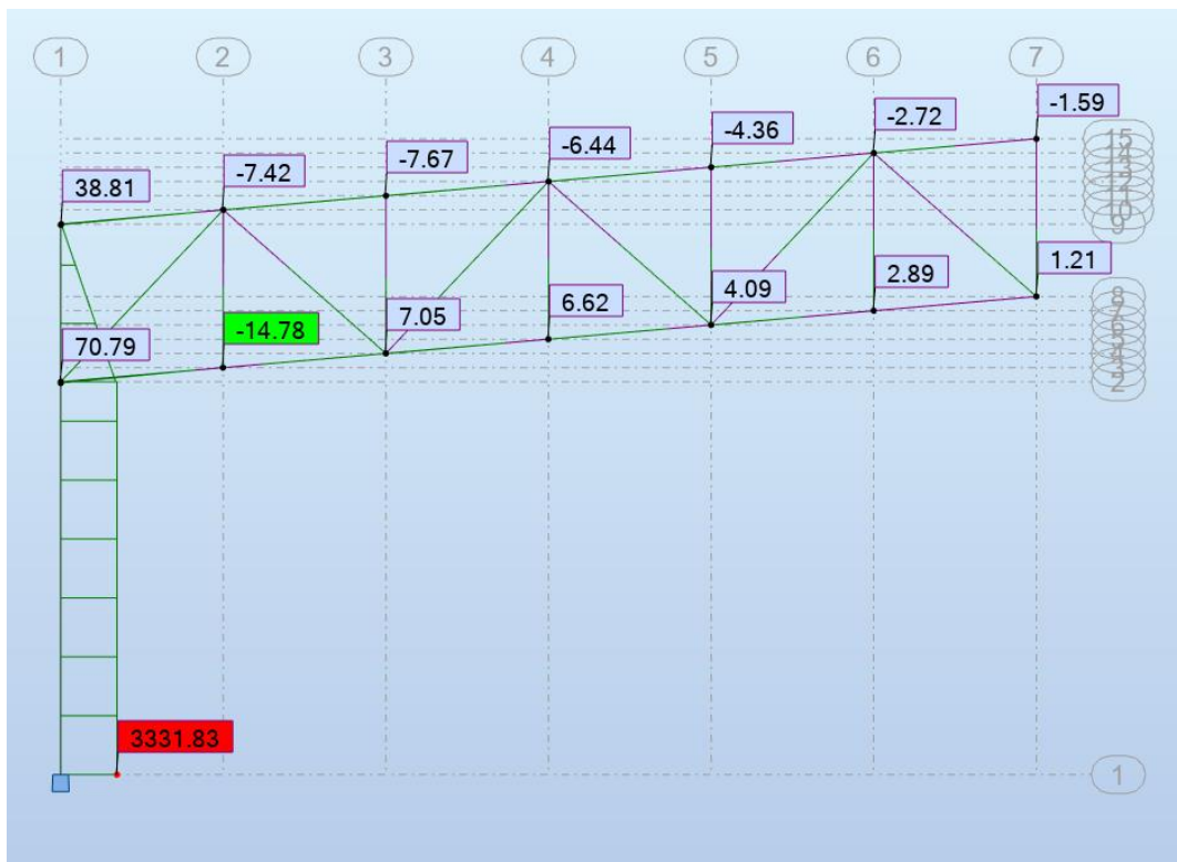
Slika 38: Dijagram momenata u nosaču za odižuće djelovanje
