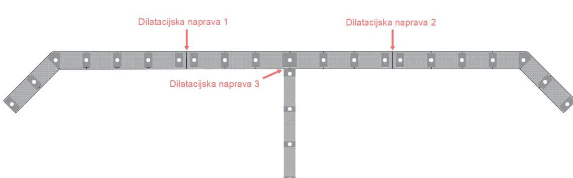
Slika 37. Položaj dilatacijskih napravi (*Izrađeno u AutoCad-u*)
