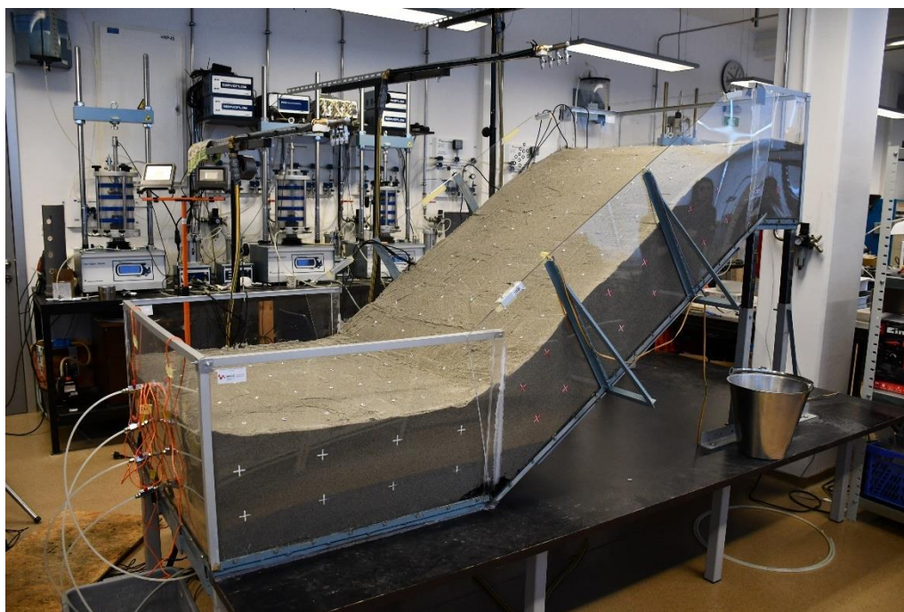
Slika 17: Umanjeni model kosine od čistog pijeska
