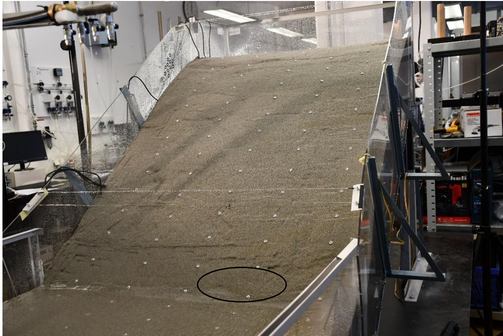
Slika 20: Pojava prve pukotine
