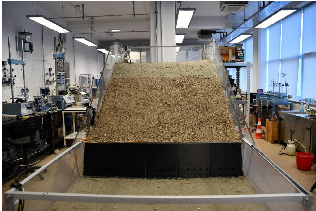
Slika 24: Prikaz modela s ugrađenim potpornim zidom
