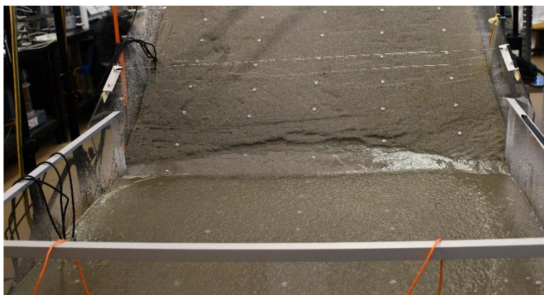
Slika 42: Retrogresivno klizanje u modelu
