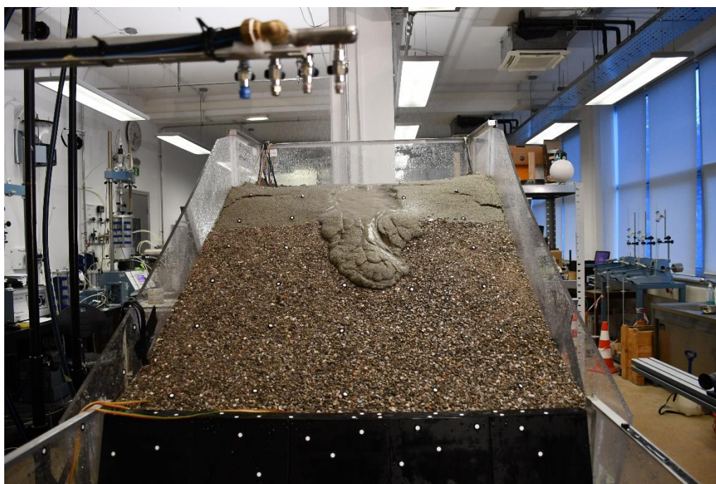
Slika 27: Tečenje pijeska uslijed velikog intenziteta oborina
