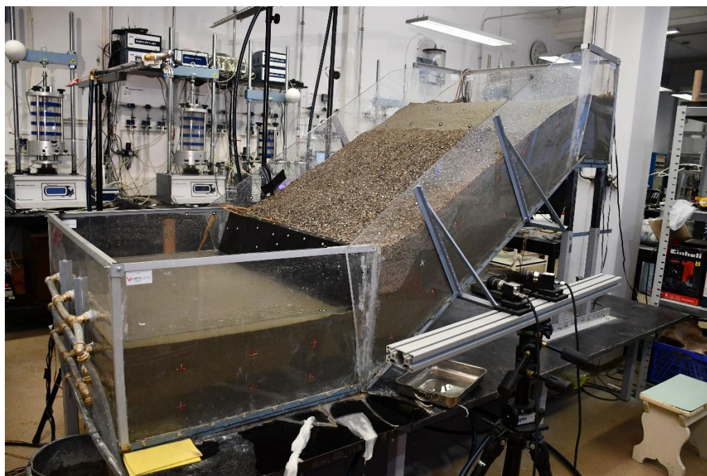
Slika 26: Potopljena nožica ispred potpornog zida
