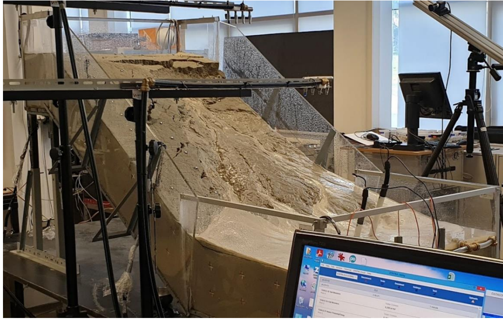
Slika 60. Prikaz rezultata ispitivanja - pojava rotacijskog klizišta u nožici modela
