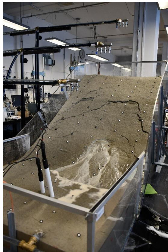
Slika 61. Prikaz kliznog tijela i potopljene nožice modela u pokusu 5
