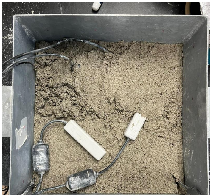
Slika 21. Prikaz ugrađenih senzora unutar Posude 3 na visini od h=10 cm
