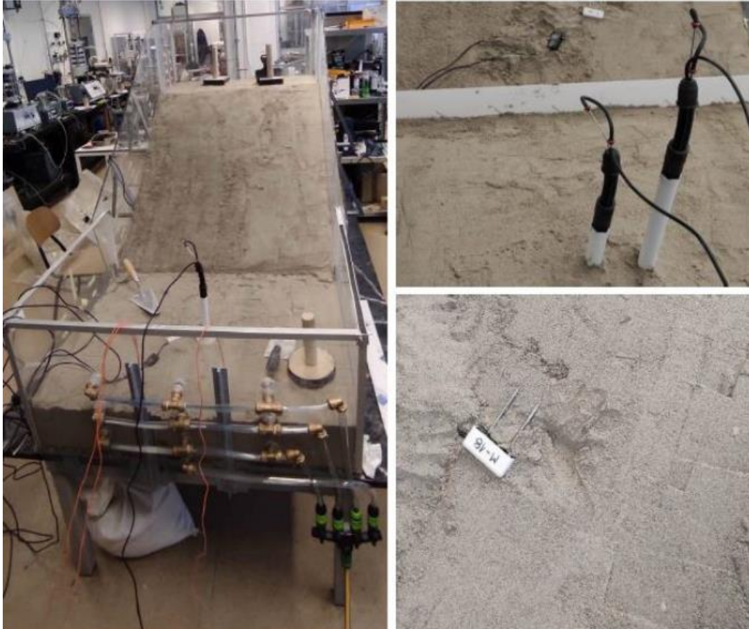
Slika 56. Prikaz umanjenog fizikalnog modela prilikom ugradnje senzora
