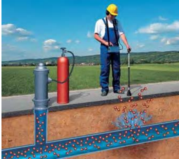
Slika 2.3 Lokalizacija gubitaka vode osluškivanjem vodoopskrbne mreže [3].
