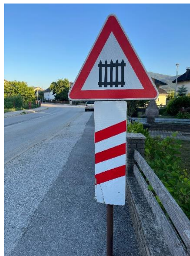
Slika 8 [10], 9 [foto autor]: znak “približavanje prijelazu ceste preko željezničke pruge bez branika ili polubranika”
