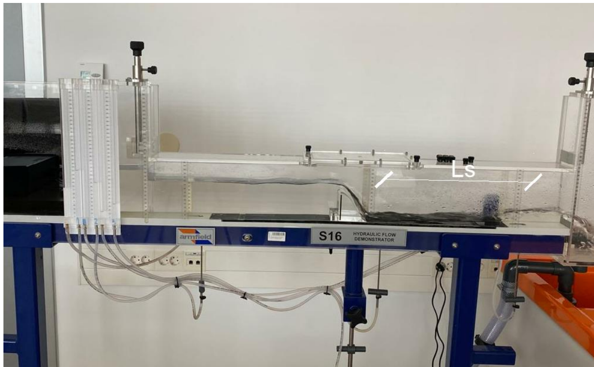
Slika 9. Određivanje duljine vodnog skoka u laboratoriju
