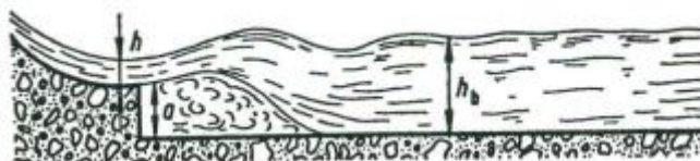
Slika 27. Spajanje vodnih razina u obliku površinskog skoka (Agroskin, 1969.)
