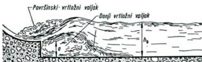
Slika 28. Spajanje vodnih razina u obliku potopljenog površinskog skoka (Agroskin, 1969.)
