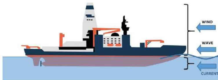
Slika 24. Opterećenja na privezno mjesto [8]
