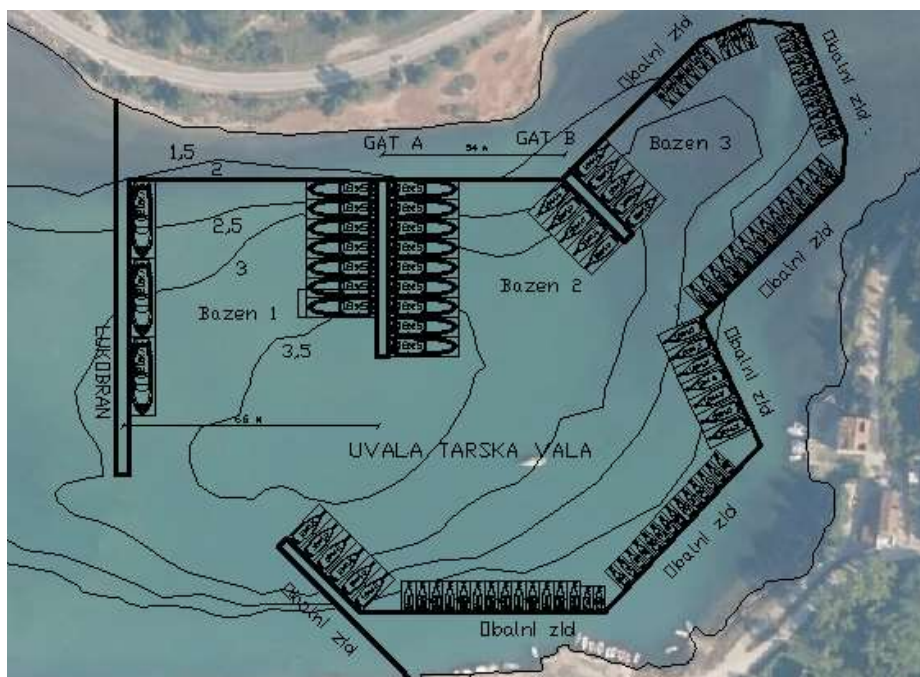
Slika 42. Razmak i raspored bazena i plutajućih gatova
