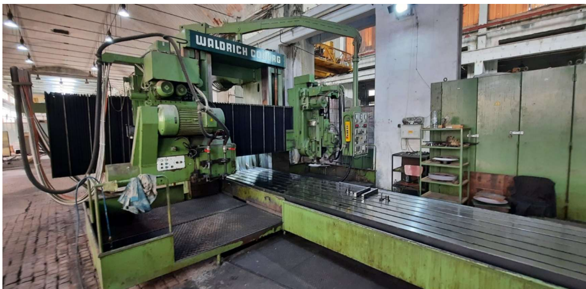
Slika 43.: Stroj za visokoprecizno plansko brušenje danas
