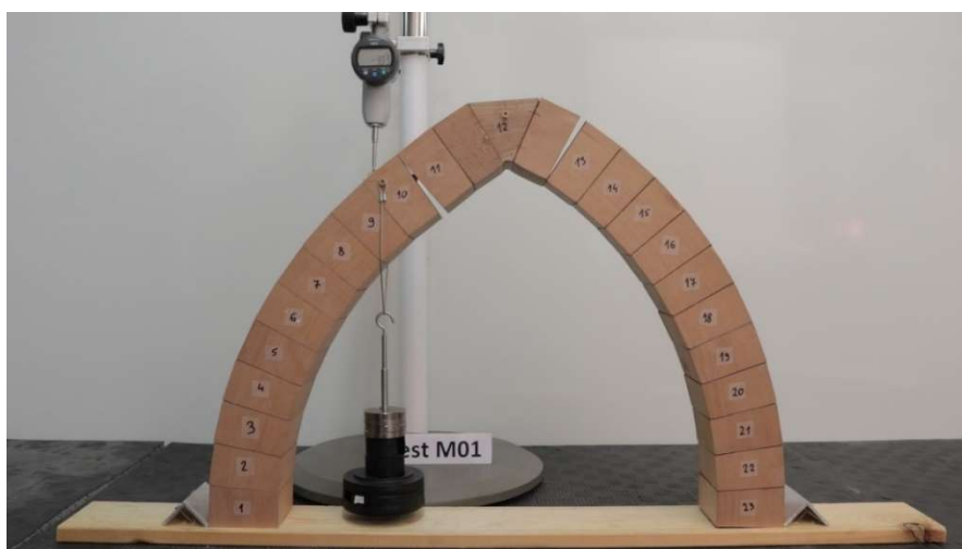
Slika 57. Model M : otvaranje trećeg zgloba između blok 23 i oslonca
