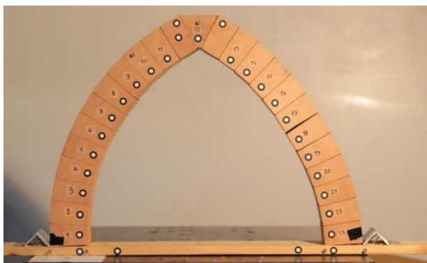
Slika 92. Otvaranje zglobova na modelu ME1P
