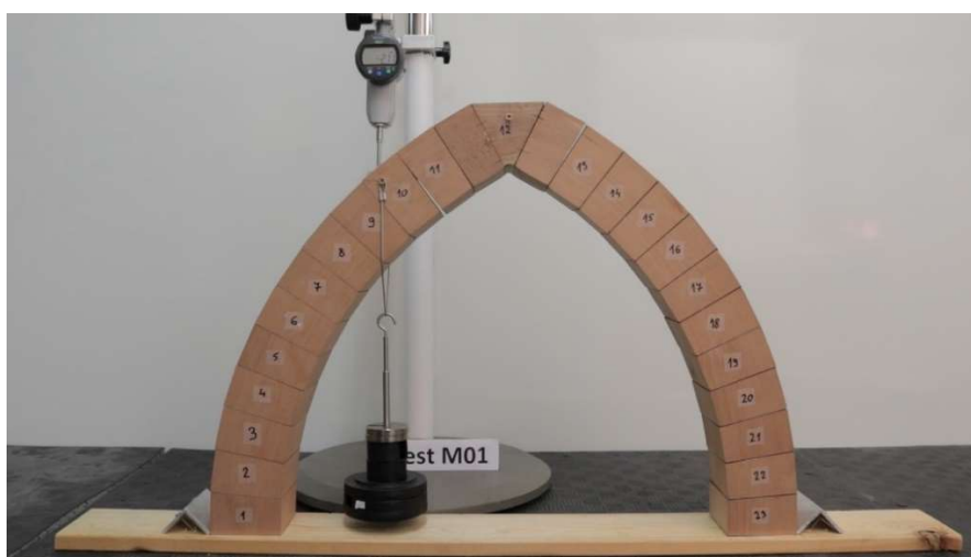
Slika 56. Model M : otvaranje drugog zgloba između bloka 12 i 13
