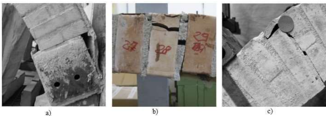
Slika 19. a) Posmično klizanje , b) drobljenje materijala, c) drobljenje + klizanje [5]
