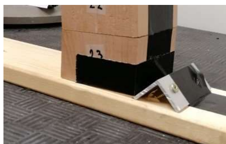
Slika 69. Detalj sidrenja pojačanja na osloncu
