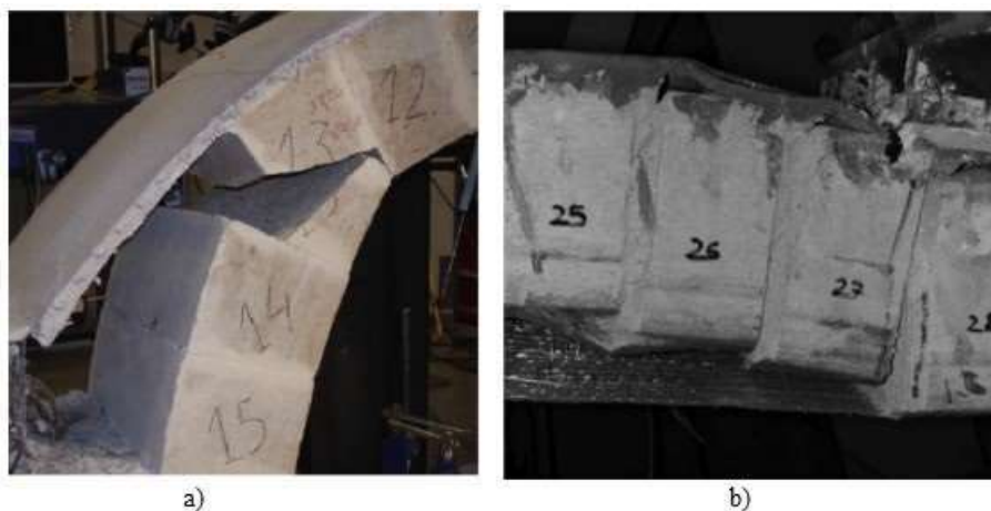
Slika 21. a) Odvajanje + drobljenje, b) posmično klizanje + odvajanje [5]
