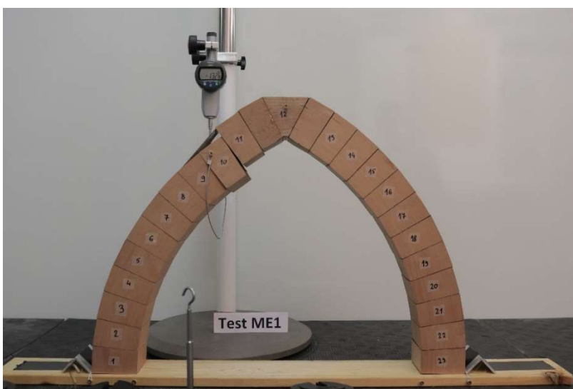
Slika 74. Slom klizanjem i odljepljivanjem
