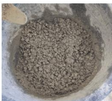
a) nedostatak vode
