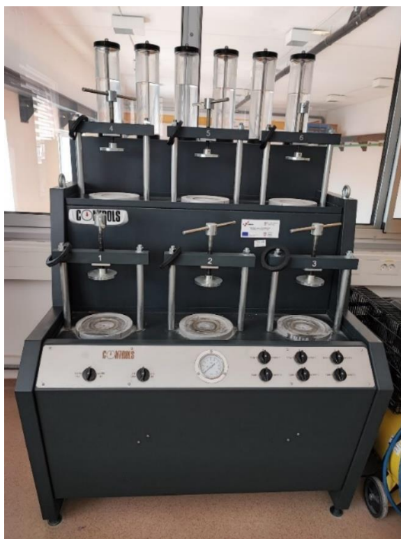
Slika 33. Uređaj za ispitivanje vodopropusnosti iz laboratorija za materijale Građevinskog fakulteta u Rijeci
