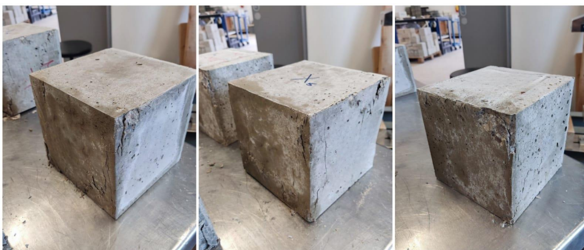
Slika 60. Betonski uzorci mješavine 3 nakon ispitivanja tlačne čvrstoće
