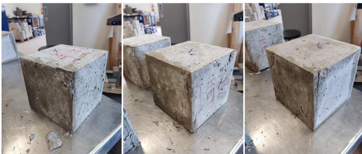
Slika 59. Betonski uzorci mješavine 2 nakon ispitivanja tlačne čvrstoće
