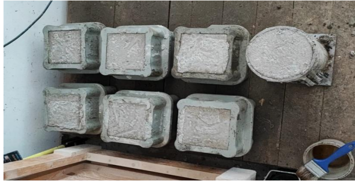
Slika 54. Beton ugrađen u kalupe
