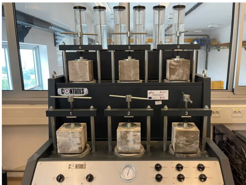
Slika 21: Uređaj za ispitivanje vodonepropusnosti betona
