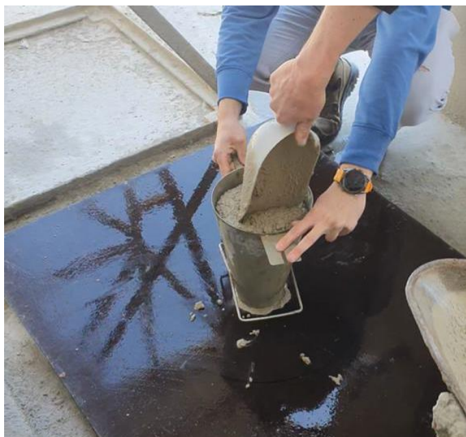
Slika 10: Priprema uzorka za ispitivanje konzistencije slijeganja rasprostiranjem
