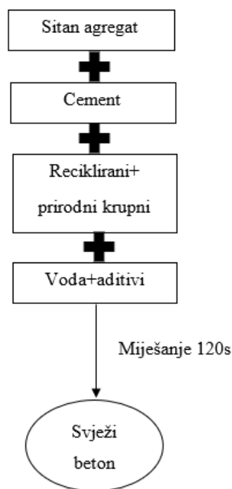
Slika 25: Shematski prikaz normalnog postupka miješanja (Jevtić i sur., 2009.)
