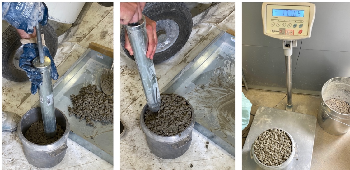
Slika 23: Postupak ispitivanja sadržaja šupljina (izvor: vlastite fotografije)
