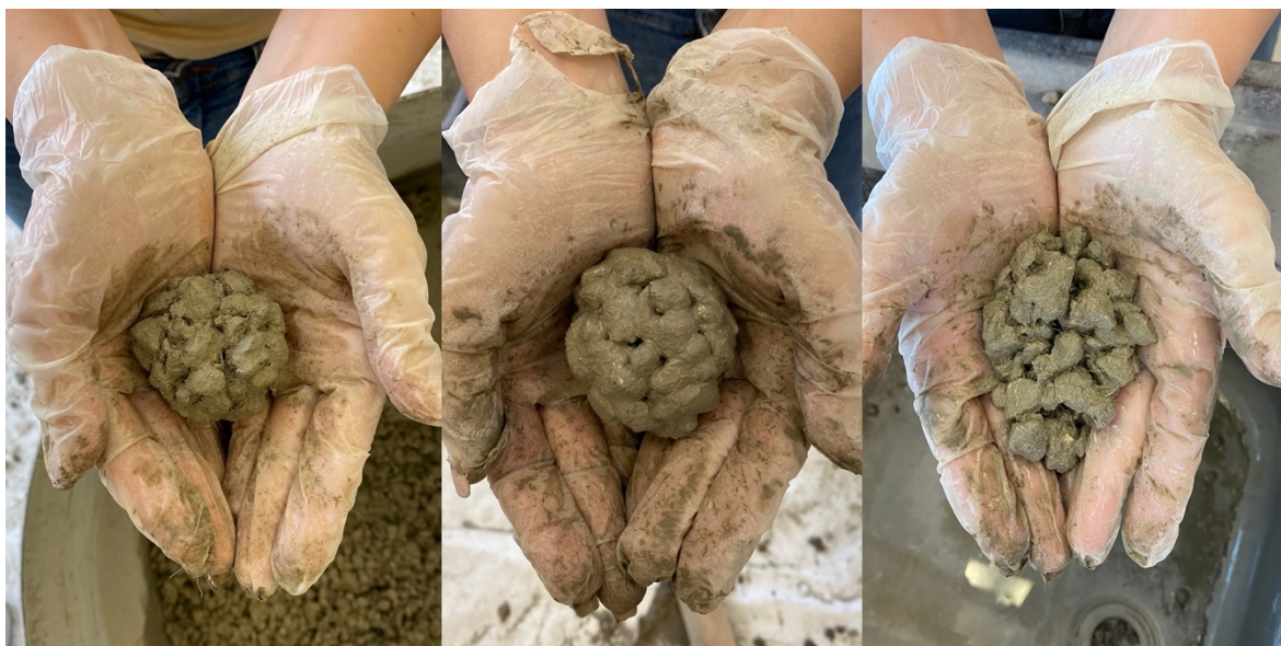
Slika 4: Ovisnost procjedbog betona o sadržaju vode: a) nedostatak vode; b) odgovarajuća količina vode; c) previše vode (izvor: vlastita fotografija)
