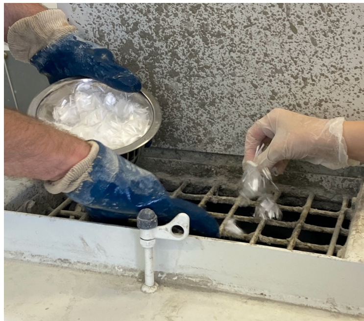
Slika 20: Ručno ubacivanje mikro vlakana (izvor: vlastita fotografija)
