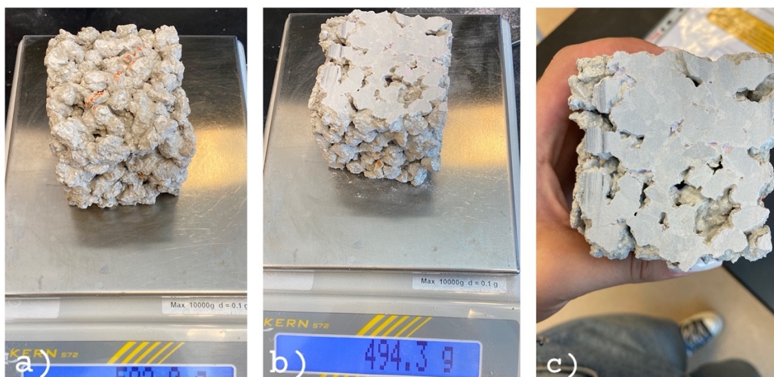
Slika 28: a) vaganje uzorka prije ispitivanja, b) vaganje uzorka nakon ispitivanja, c) površina uzorka nakon ispitivanja, (izvor: vlastite fotografije)
