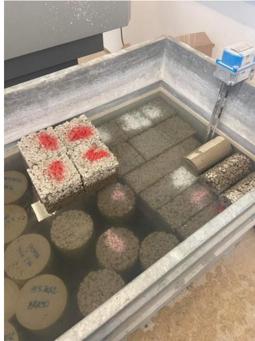
Slika 19: Uzorak procjdnog betona u bazenu za njegovanje (izvor:: vlastita fotografija)
