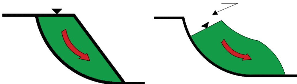
Slika 6. Rotacijsko klizište, prije i poslije pomaka materijala niz kliznu plohu [1]
