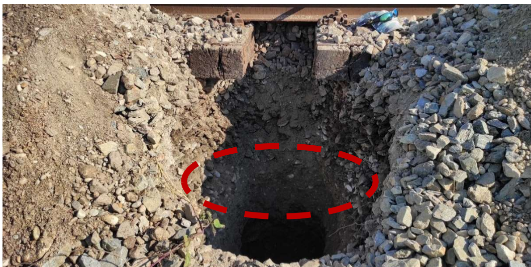
Slika 21. Naslage geotehničke jedinice 4 - Tucanika/Tampona u sklopu sondažne jame SJ-10 (Geotech d.o.o.)
