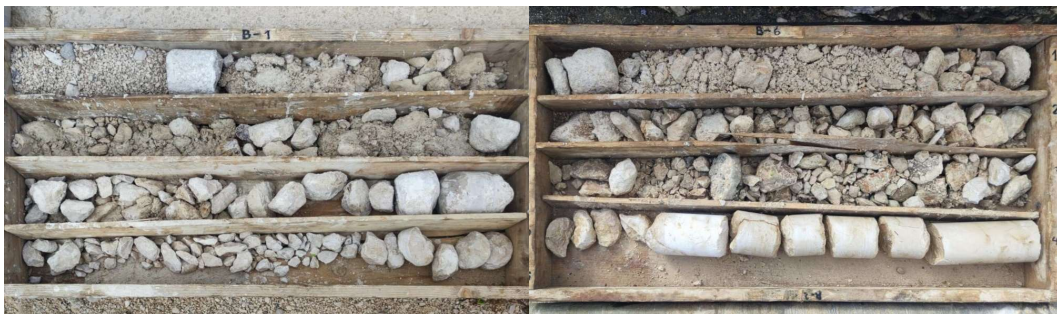
Slika 3. Primjer izbušene jezgre stijenske mase pohranjene u sanduku
