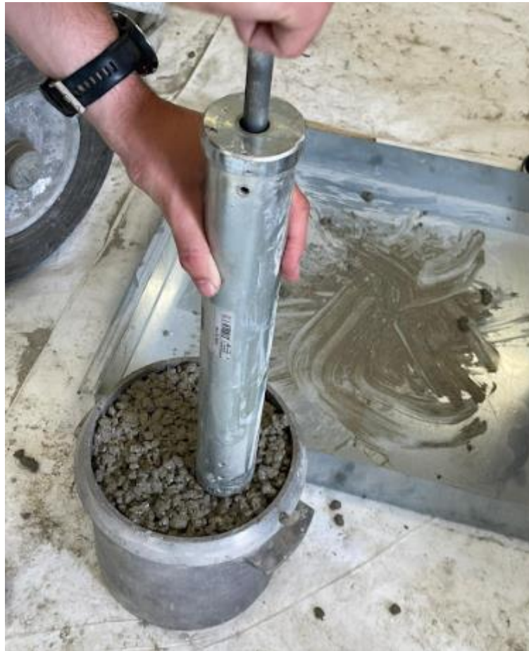
Slika 24: Priprema uzorka za ispitivanje sadržaja šupljina (izvor: vlastita fotografija)
