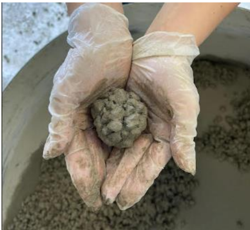
Slika 8: Ispitivanje konzistencije metodom kuglice (izvor: vlastita fotografija)
