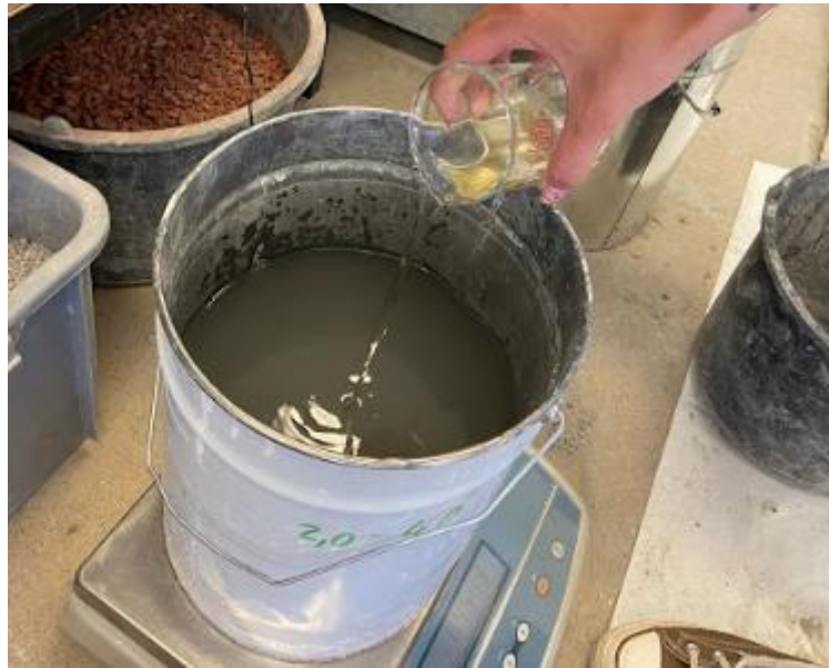
Slika 18: Dodavanje superplastifikatora u vodu (izvor: vlastita fotografija)
