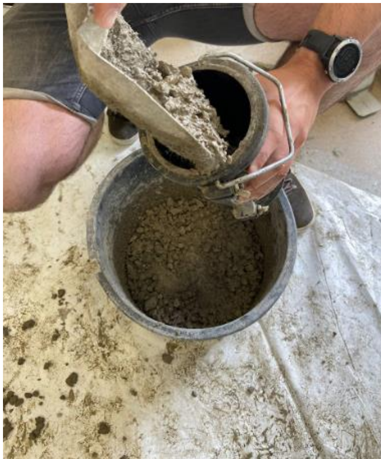
Slika 21: Ugradnja običnog betona u kalup oblika valjka dimenzija \varnothing 100 x 200 mm (izvor: vlastita fotografija)
