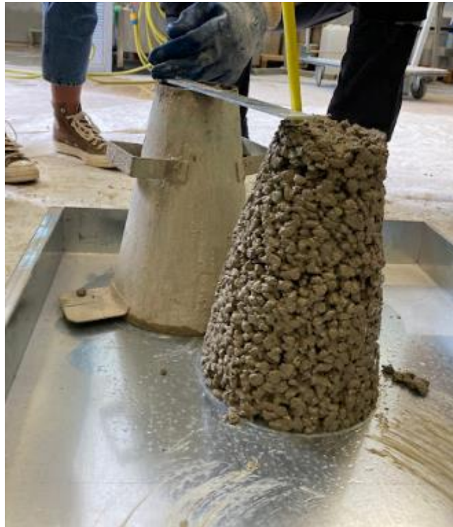
Slika 23: Mjerenje konzistencije slijeganjem (izvor: vlastita fotografija)
