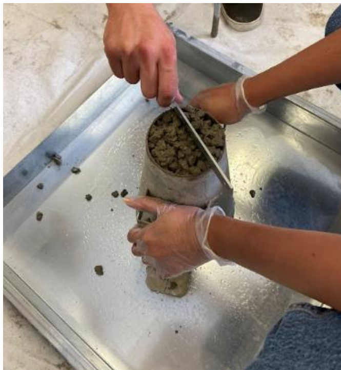
Slika 22: Priprema uzorka za ispitivanje konzistencije slijeganjem (izvor: vlastita fotografija)
