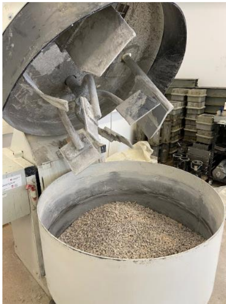
Slika 17: Suhi sastojci u rotirajućem bubnju spremni za suho miješanje (izvor: vlastita fotografija)
