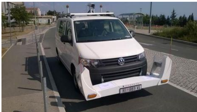
Slika 35. Mjerno vozilo opremljeno laserskim profilometrom [25]
