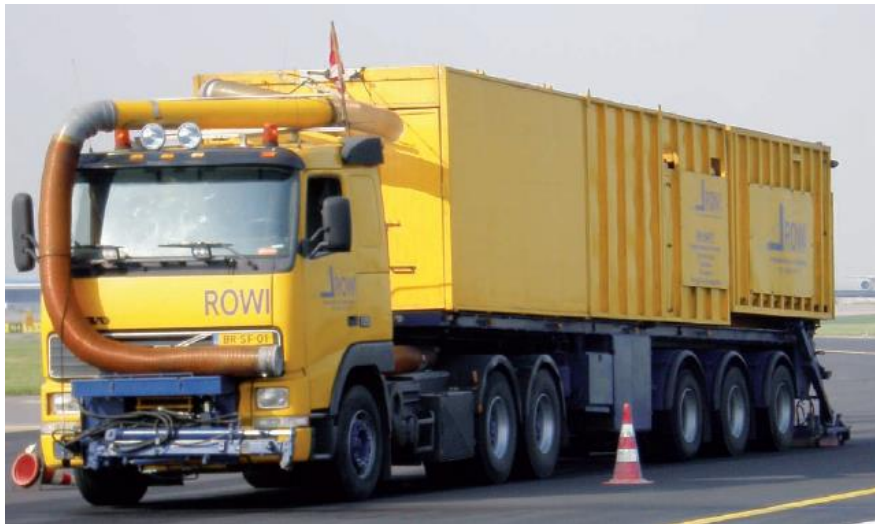
Slika 39. Stroj za visokotlačni pritisak vodenim mlazom [24]
