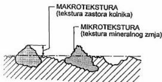
Slika 30. Makrotekstura i mikrotekstura [17]
