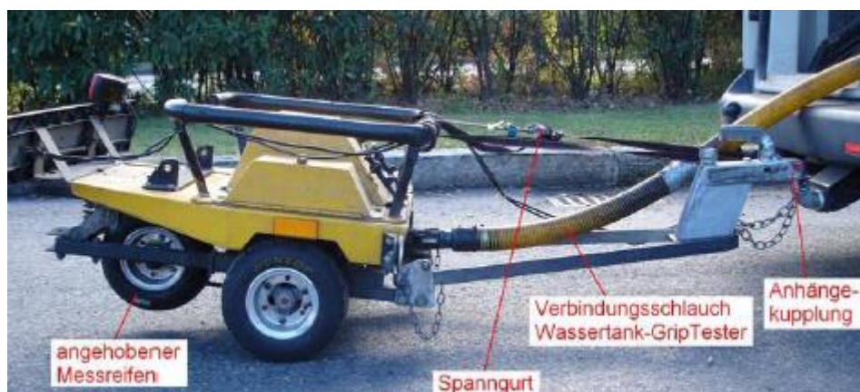
Slika 32. Dinamički uređaj – skidometar [23]
