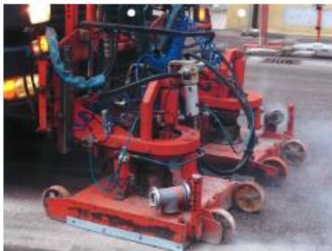
Slika 40. Stroj za hrapavljenje trimiks metodom [27]
