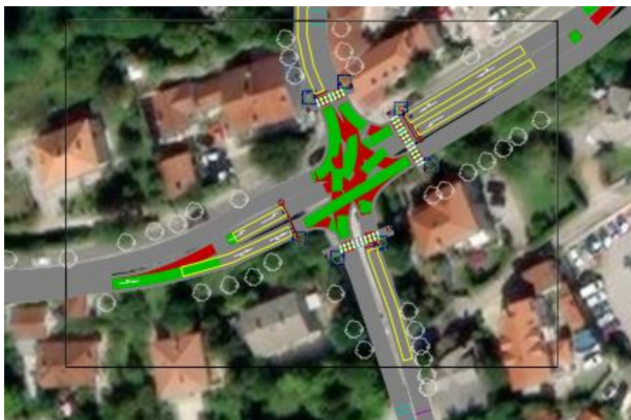
Slika 38: Prikaz modela raskrižja Spar u programskom alatu Vissim
