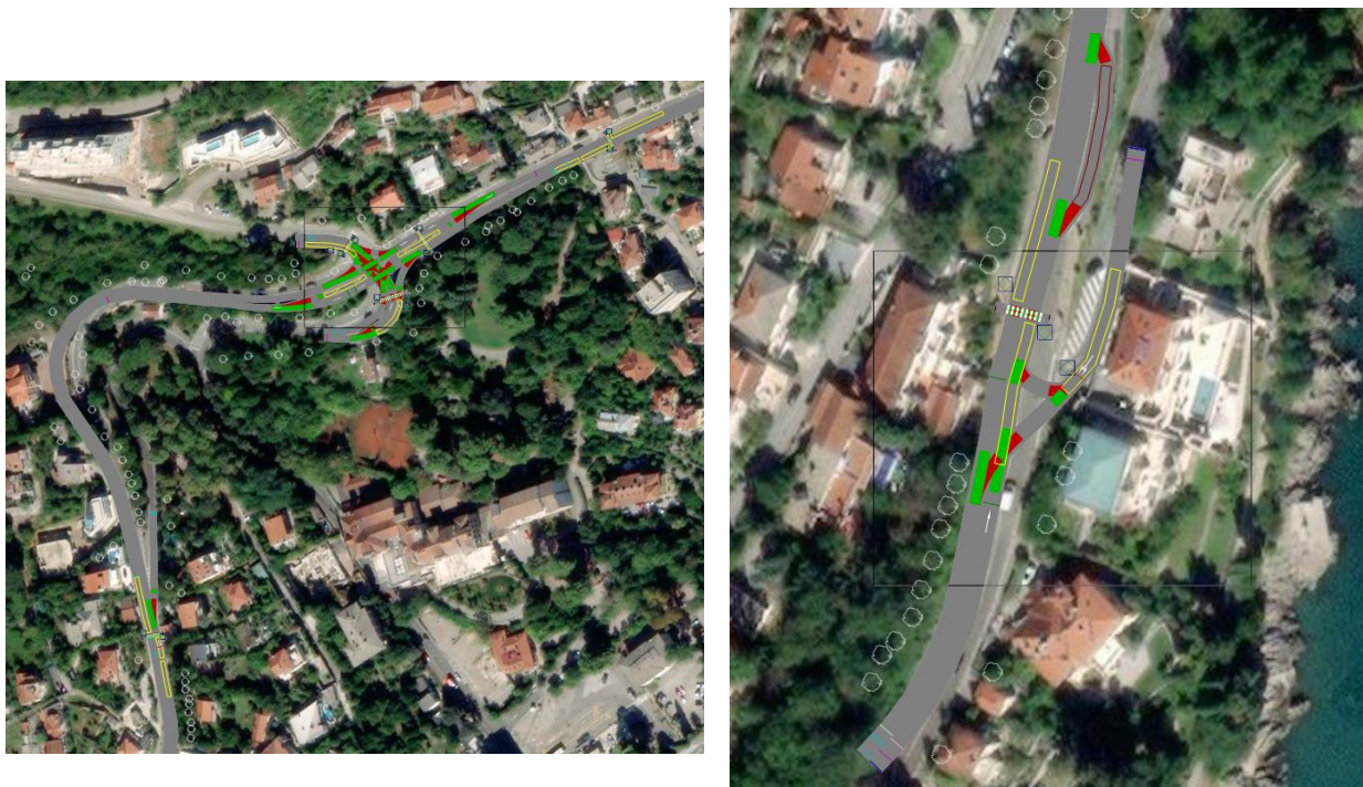
Slika 39: Prikaz modela raskrižja Vrutki (lijevo) i Punta Kolova (desno) u programskom alatu Vissim
