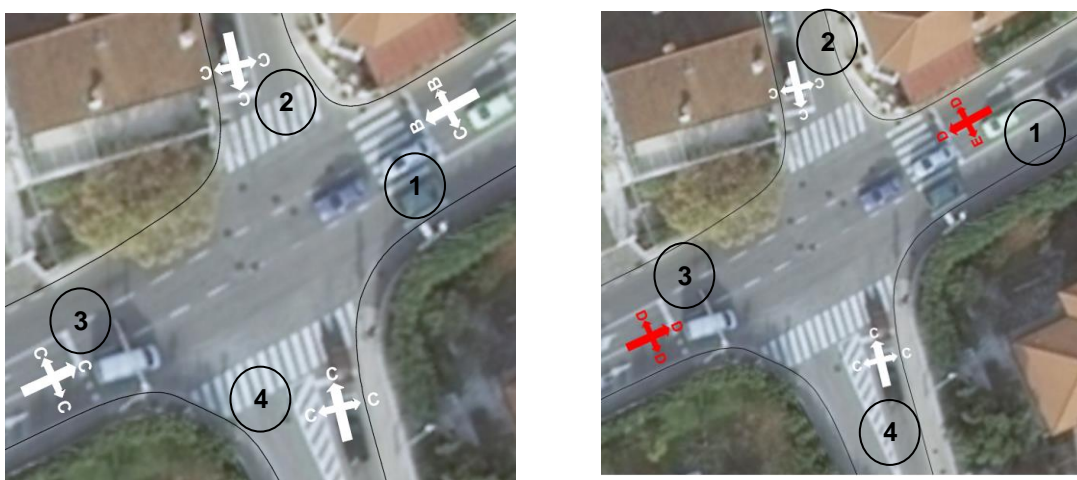
Slika 40: Razine uslužnosti za sve privoze i kretanja na raskrižju Spar prema vanezonskom (lijevo) i sezonskom (desno) prometnom opterećenju
