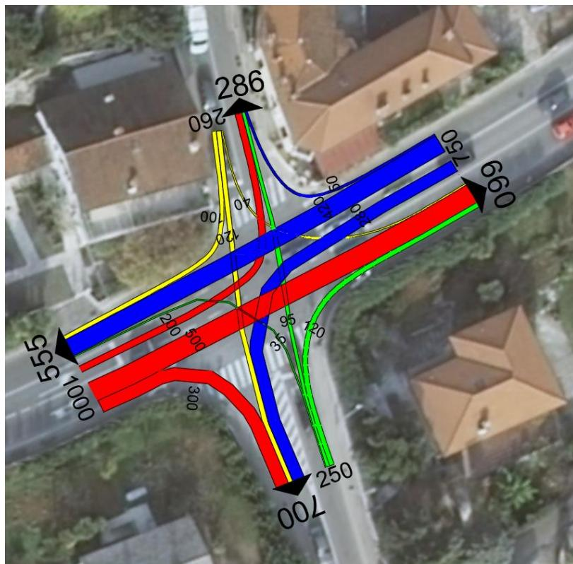
Slika 25: Prikaz prepostavljenog grafičkog opterećenja u vršnom satu na raskrižju Spar
