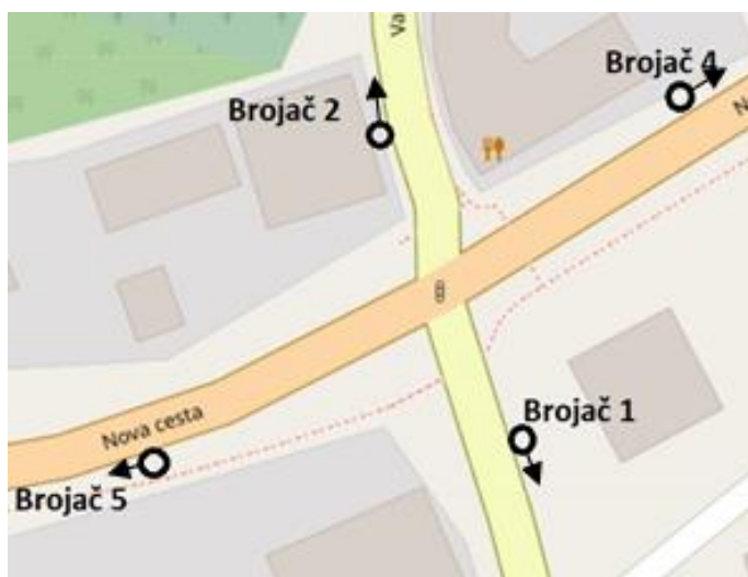
Slika 23: Prikaz mjesta i smjera brojača na raskrižju Spar
