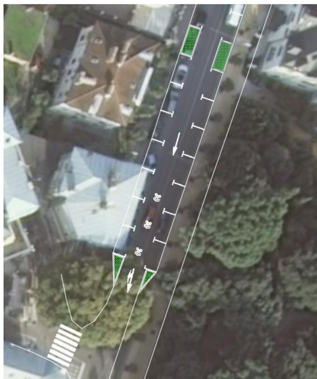
Slika 55: Prikaz dijela novog idejnog rješenja ulice
