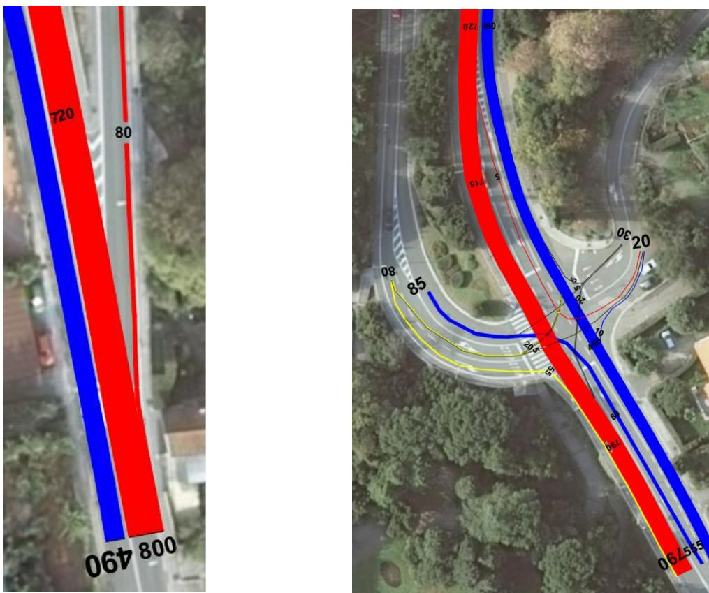
Slika 31: Prikaz prepostavljenog grafičkog opterećenja u vršnom satu na raskrižju Vrutki
