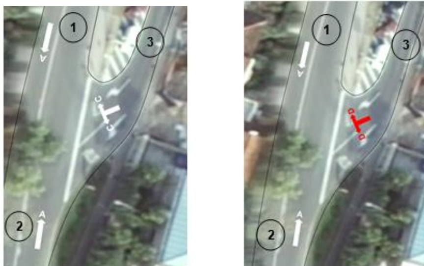
Slika 43: Razine uslužnosti za sve privoze i kretanja na raskrižju Punta Kolova prema vanezonskom (lijevo) i sezonskom (desno) prometnom opterećenju
