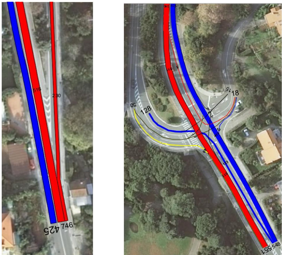
Slika 30: Prikaz grafičkog opterećenja u vršnom satu na raskrižju Vrutki
