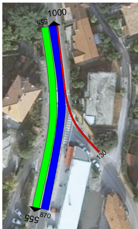
Slika 28: Prikaz pretpostavljenog grafičkog opterećenja u vršnom satu na raskrižju Tržnica
