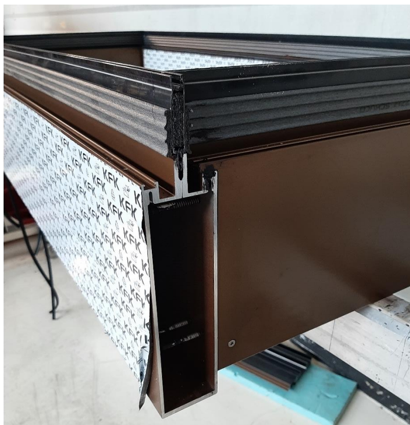
Slika 17. Okvir od aluminijskih profila
