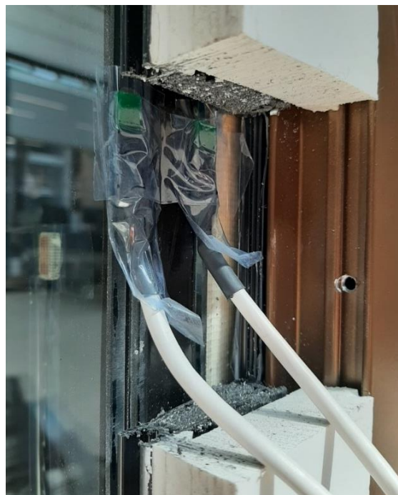
Slika 32. Sonde pričvršćene na rubove stakla
