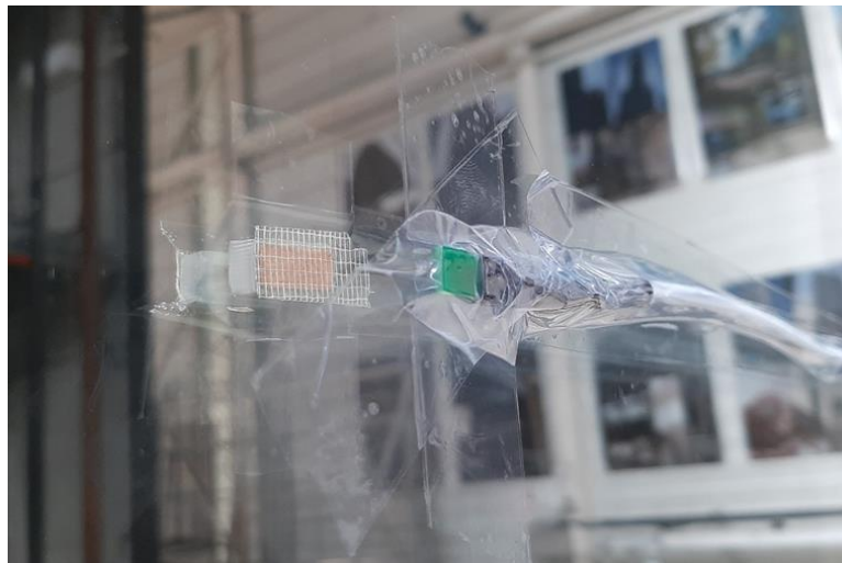
Slika 31. Sonde pričvršćene na plohu stakla i lima
