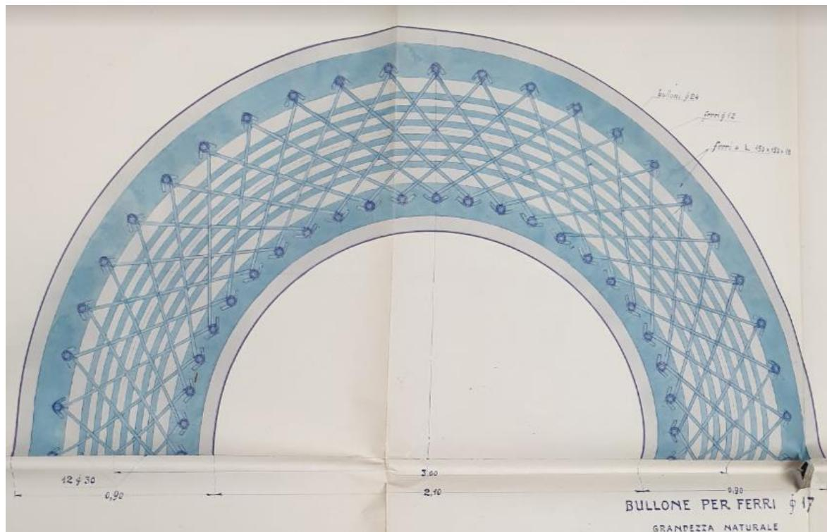
Slika 37: Tlačni prsten uz svjetlarnik [4]
