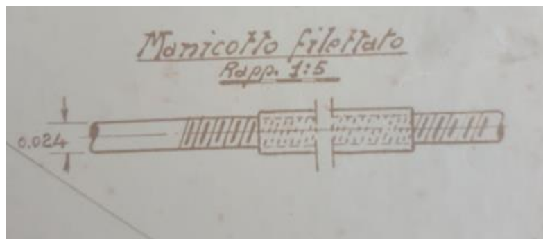
Slika 57: Mehanička spojnica armature u prstenu [4]
