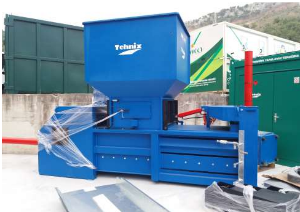
Slika 26. Stroj za prešanje i baliranje ( Izvor: Grad Omiš, Upravni odjel za komunalnu i stambenu djelatnost, prostorno uređenje i zaštitu okoliša, pristup rujan 2022.)
