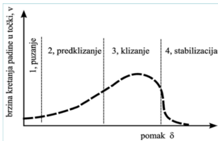
Slika 1. Faze pomicanja tla na kosini [3]
