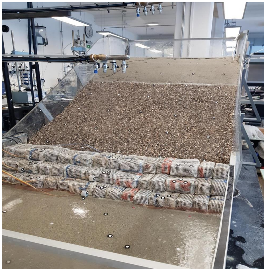
Slika 37: Potpuno potapanje nožice ( t=135 min)
