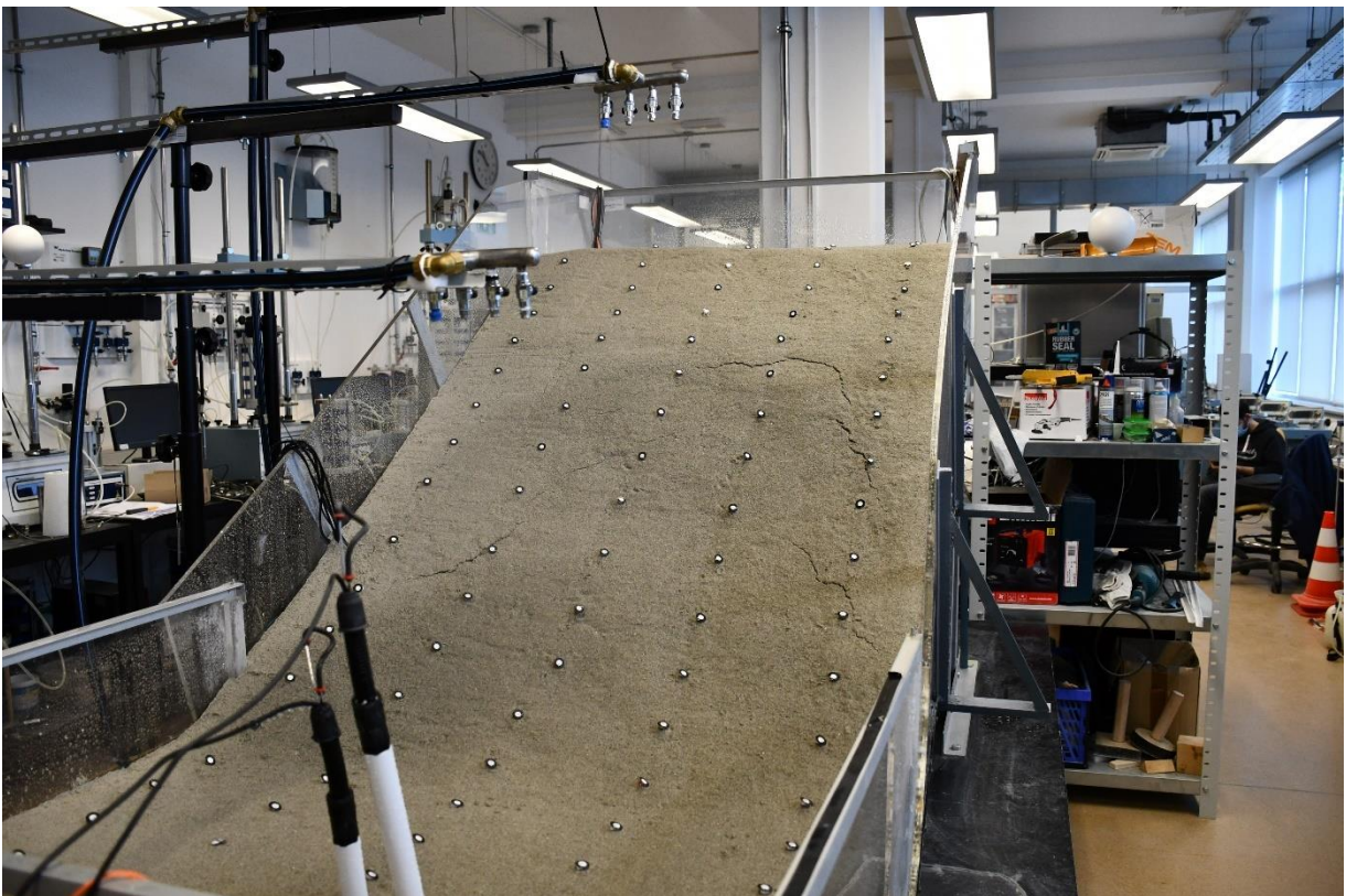
Slika 21: Pojava nekoliko pukotina u modelu bez mjera sanacije (t=35 min)
