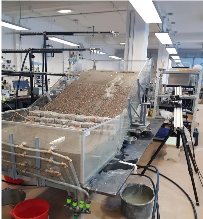
Slika 38: Ispiranje materijala preko zone sanacije
