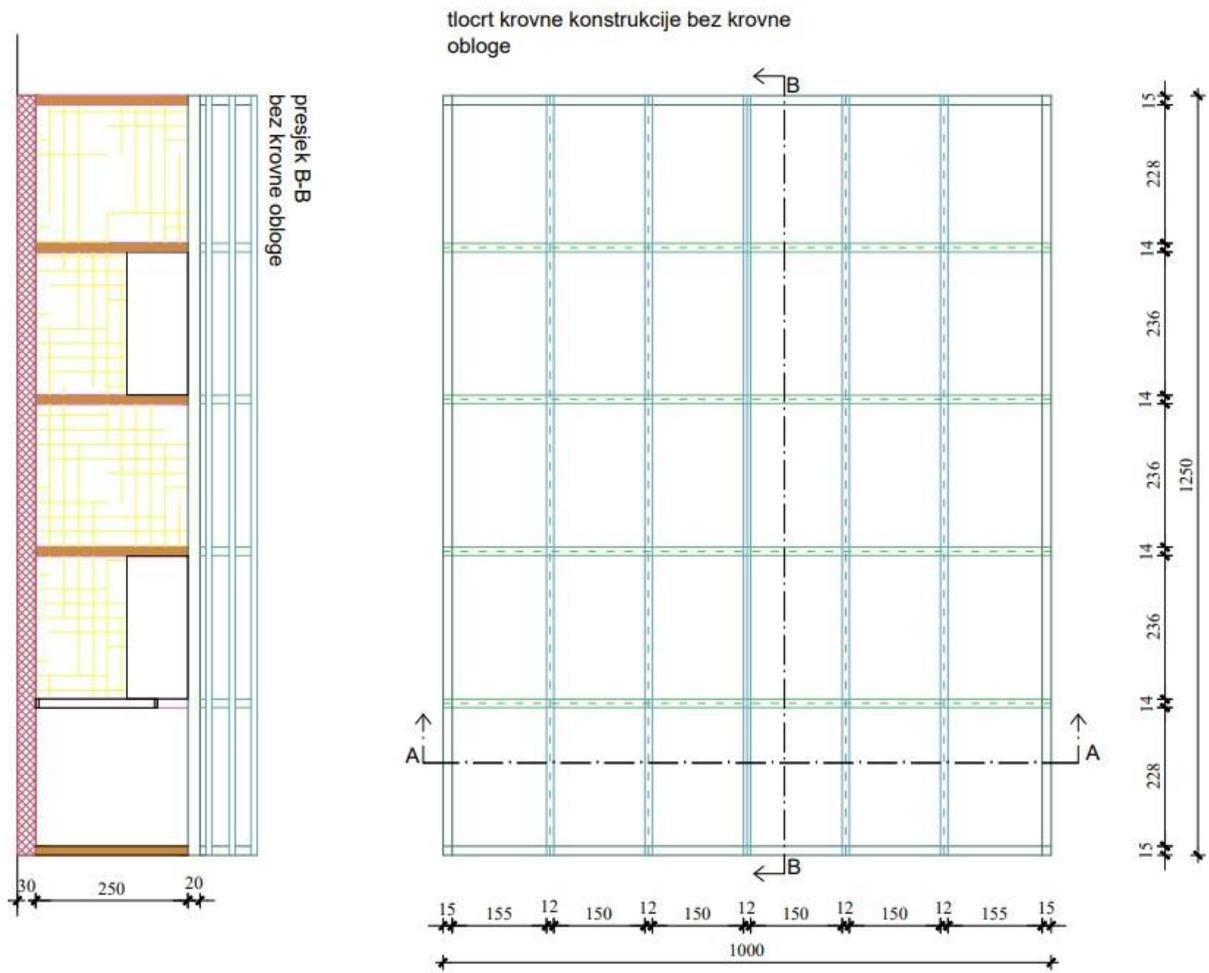
Slika 25: Tlocrt krovništa i uzdužni presjek (izradila autorica)
