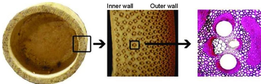
Slika 10: Mikroskopski prikaz unutrašnjosti presjeka bambusa (Research Gate)
