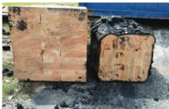
Slika 6. Drvo nakon požara
